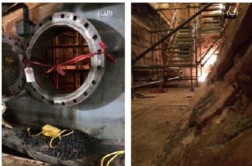
شکل ۲-۲: (الف) ورودی محفظه احتراق، (ب) الیاف نسوز سرامیکی داخل محفظه احتراق [۲۰]
