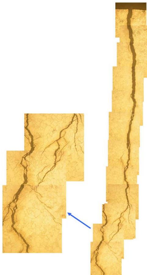
شکل ۲-۲) ترک خوردگی-تنشی در لوله‌های بخار [۱۰]
