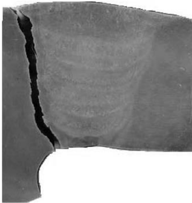
شکل ۲-۷) نمونه‌ای از ترک نوع IV در منطقه ریزدانه HAZ فولاد P91 [۱۷]
