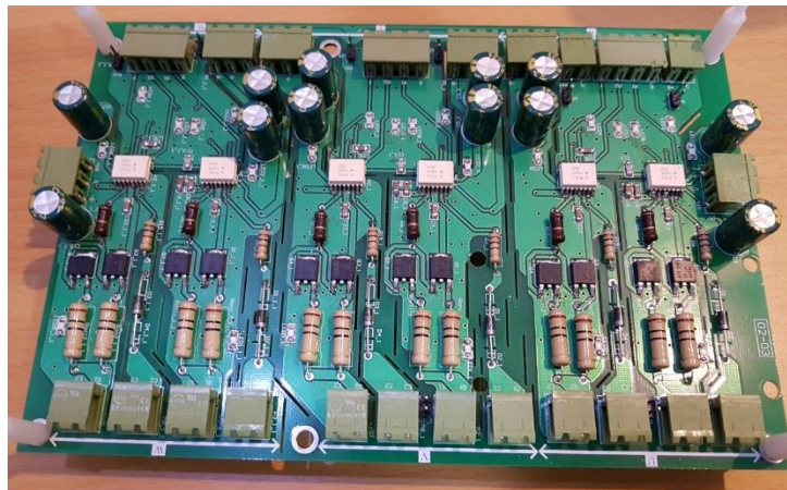
شکل ۹۰-۳: مدار درایور IGBT
