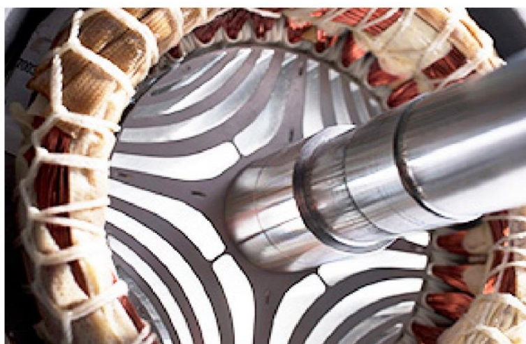
شکل ۱-۳- طرح رتور LSSynRM کمپانی ABB [۱۳]
