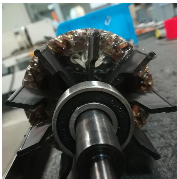
شکل ۱۸-۱۳- محل اضافه کردن وزنه ها برای بالانس شدن روتور
