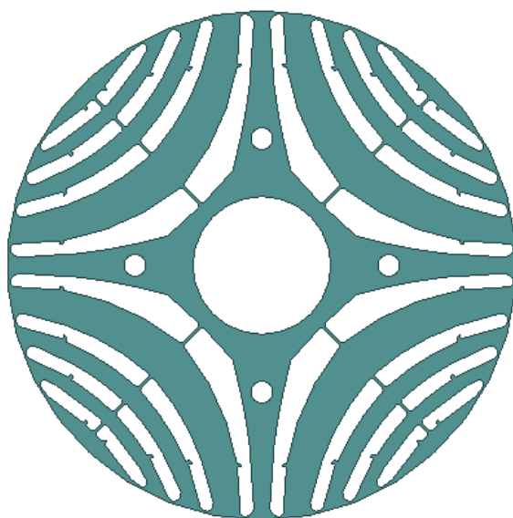
شکل پ ۵. دید از بالا روتور سنکرون رلوکتانسی
