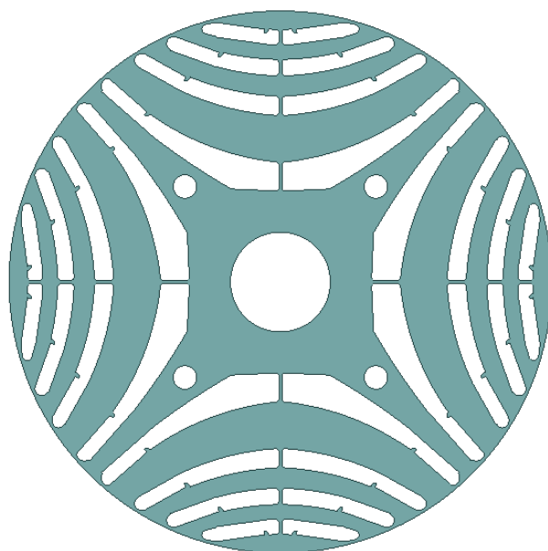
شکل پ ۴: دید از بالا روتور SynRM
