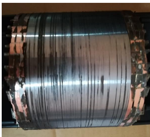
شکل ۱۶-۱۳- روتور بعد از تراشکاری
