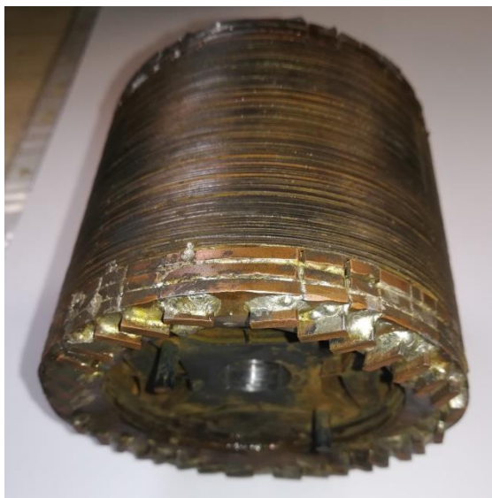
شکل ۱۱-۱۳- تصویر روتور بعد از اتصال همه حلقه های اتصال کوتاه
