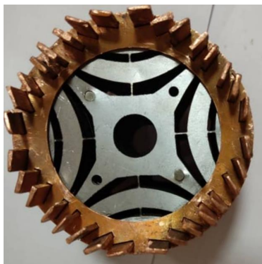
شکل ۹-۱۳- روتور قبل از بریز
