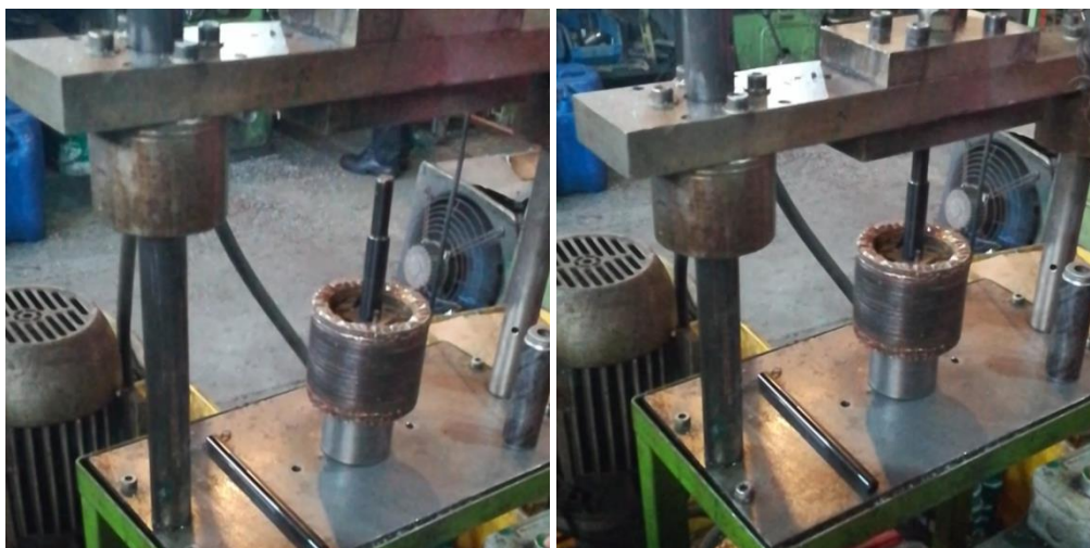
شکل ۱۴-۱۳- جازدن محور با دستگاه پرس
