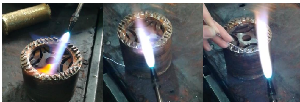
شکل ۱۰-۱۳- اتصال میله ها به حلقه های اتصال کوتاه با بریز آتش
