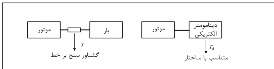
شکل ۲-۲- روش های اندازه گیری گشتاور (شکل از استاندارد IEC 60034-2-1)
