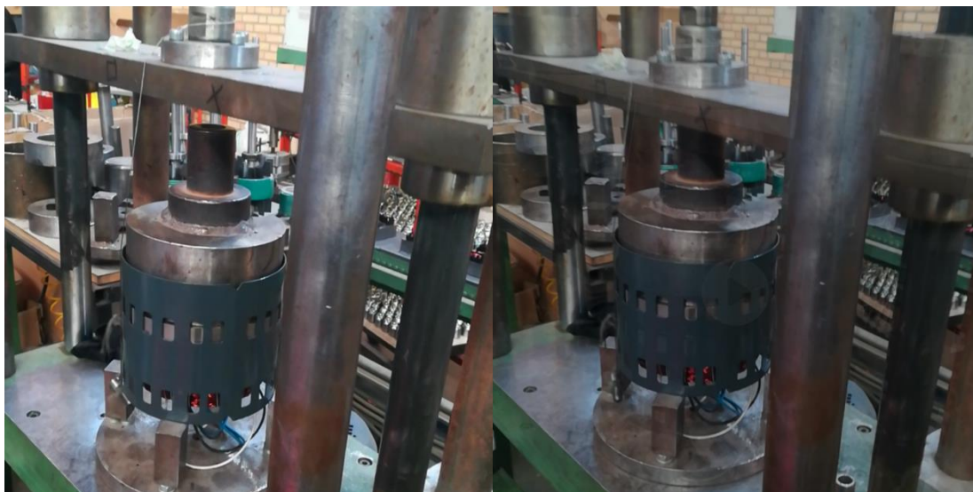
شکل ۱۹-۱۳- جا زدن پشته استاتور به داخل بدنه
