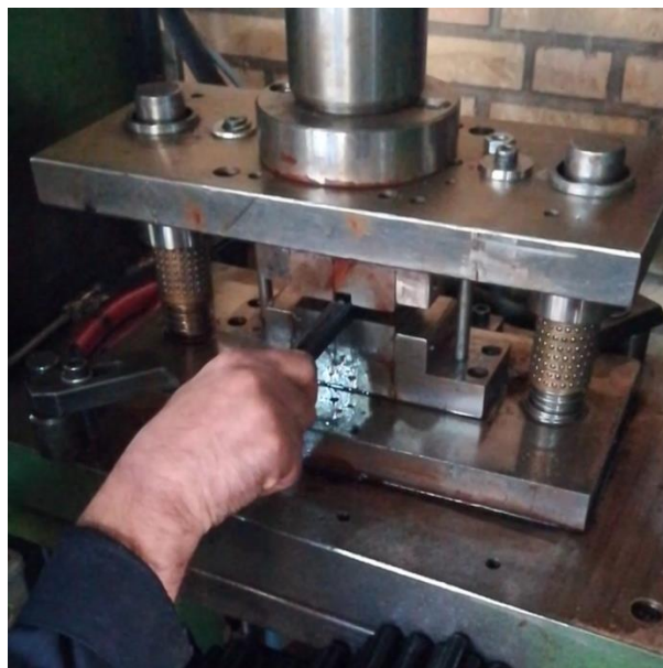
شکل ۱۳-۱۳- آج زدن محور
