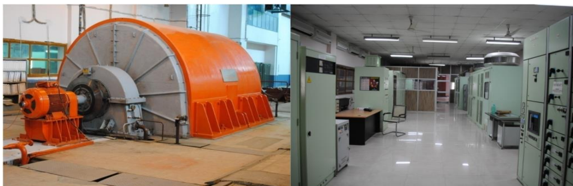
شکل ۱-۲۰: تصویر ژنراتور اتصال کوتاه ۱۵۰۰ مگاوات‌آمپر تأمین‌شده توسط Alstom و اتاق کنترل آن در آزمایشگاه CPRI [۹]
