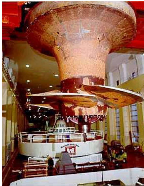
شکل ۱-۱۲: چرخ توربین کاپلان با پره‌های قابل تنظیم [8]
