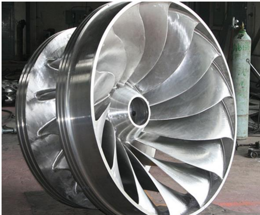
شکل ۱-۱۱: چرخ توربین فرانسسیس با ۱۴ پره [7]
