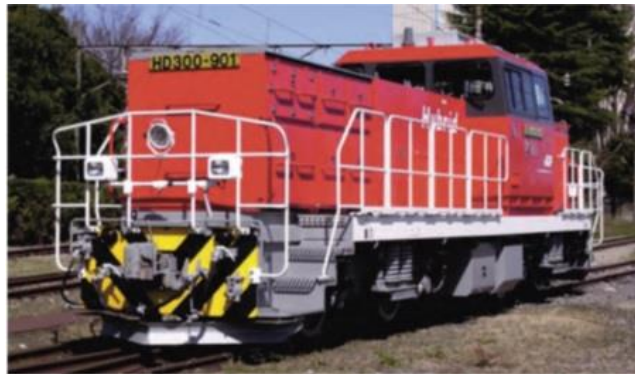
شکل ۷-۲ تصویر لوکوموتیو مانوری هیبرید سری HD300 [۸]
