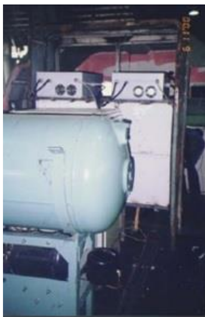
شکل ۲-۲ لوکوموتیو هیبریدی در حال نصب تجهیزات و بازسازی شاسی
