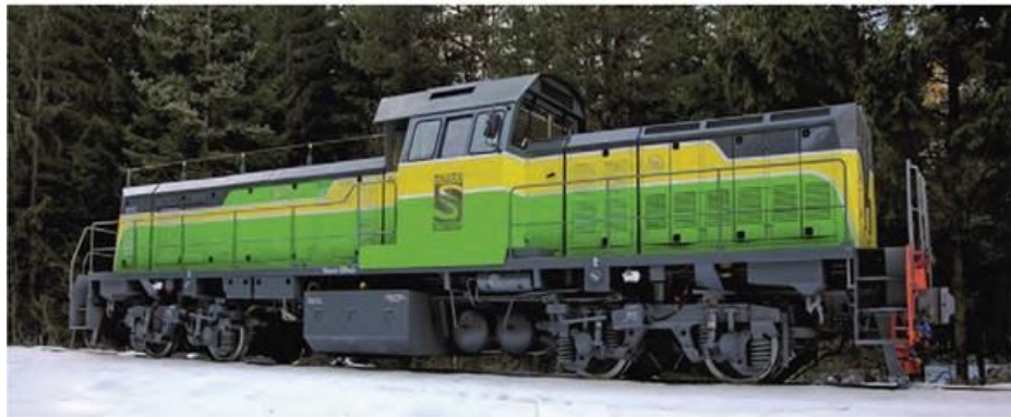
شکل ۲-۱۴ تصویر لوکوموتیو مانوری هیبرید سینارا TEM9H محصول روسیه [۱۰] مشخصات فنی این لوکوموتیو در جدول ۲-۲ نشان داده شده است.
