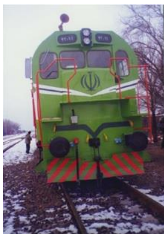
شکل ۴-۲ نمای لوکوموتیو هیبریدی از جلو و عقب در حال تست عملکرد
