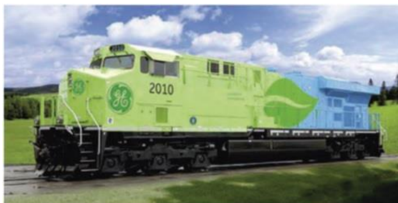
شکل ۲-۱۹ تصویر لوکوموتیو مانوری هیبرید Evolution محصول شرکت GE کشور ایالات متحده [۱۶]
