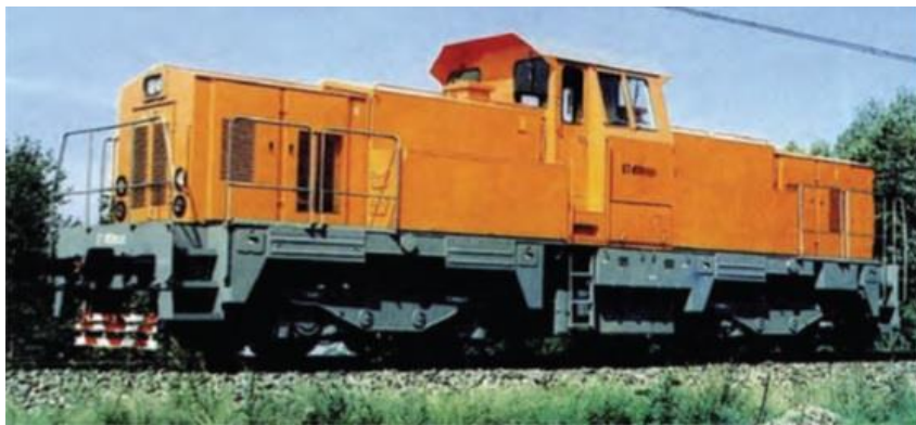
شکل ۲-۲۲ تصویر لوکوموتیو مانوری هیبرید Rada 718 محصول کشور چکوسلاواکی [۱۹]
