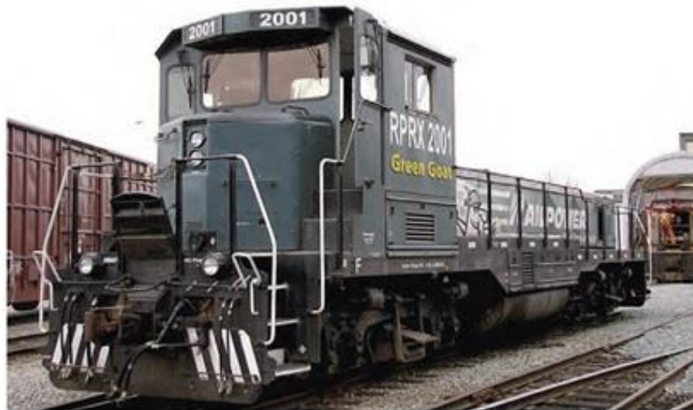
شکل ۲-۱۵ تصویر نمونه اولیه لوکوموتیو مانوری هیبرید GG20B Green Goat [۱۲]
