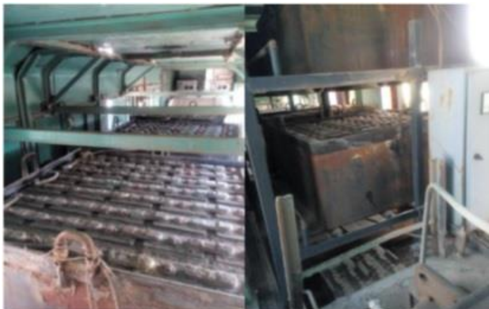
شکل ۴-۵: استفاده از باتری سرب- اسید در لوکوموتیو هیبرید داخلی ساخته شده در سال ۱۳۷۹
