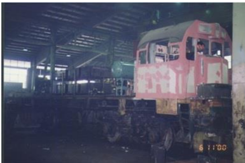
شکل ۲-۲ لوکوموتیو هیبریدی در حال نصب تجهیزات و بازسازی شاسی
