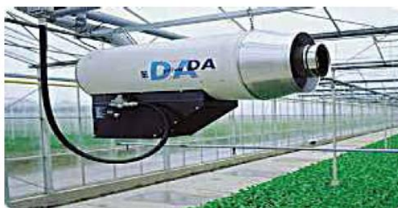
شکل ۲۷.۱ نمای سیستم تولید و تزریق دی اکسید کربن در فضای گلخانه [۸]
