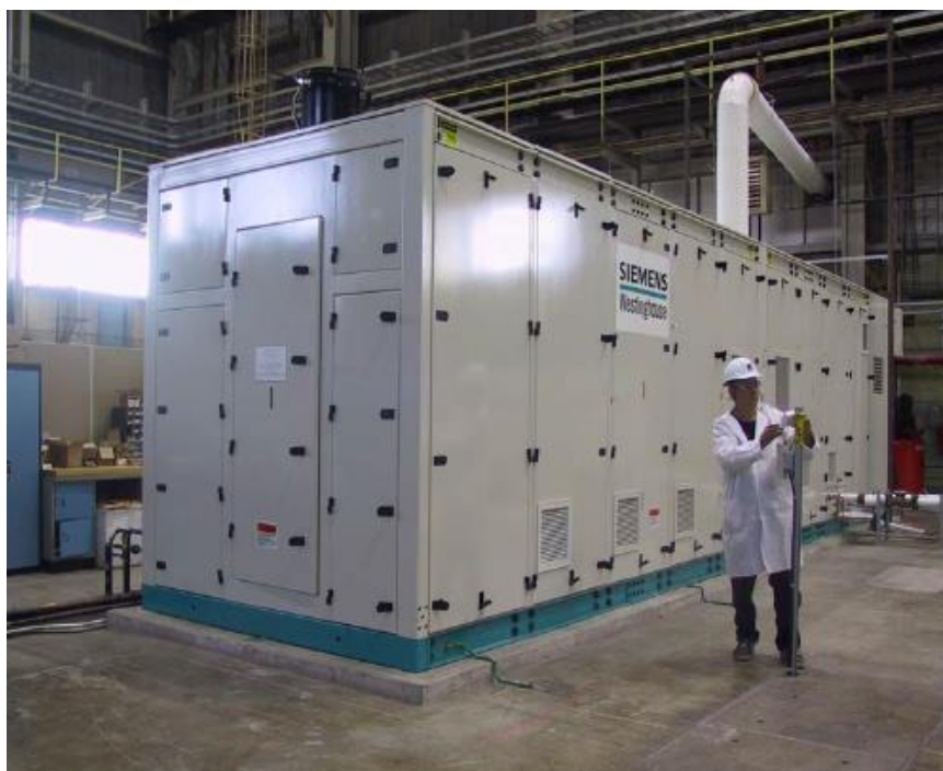
شکل ۳۲.۲ نیروگاه ۲۵۰ کیلوواتی پیل سوختی با رانندمان ۴۵ درصد [۱۸]
