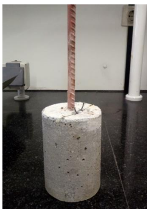
شکل ۲۷-۲- نمونه‌های بتنی تهیه شده برای آزمون امپدانس الکتروشیمیایی.
