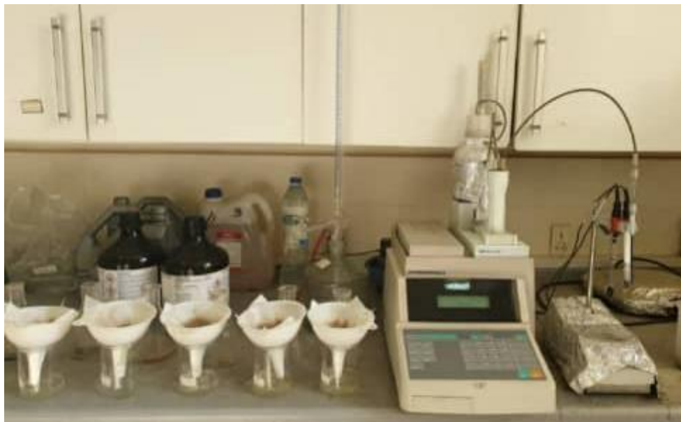
شکل ۳۷-۲- آنالیز شیمیایی یون کلر در نمونه‌های پودری بتن.
