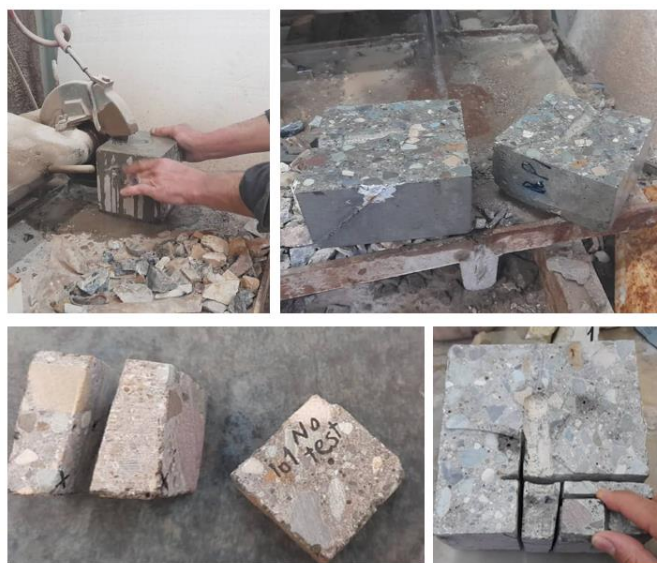
شکل ۴۲-۲- مراحل تهیه نمونه برای بررسی ریزساختاری از نمونه‌های بتنی.
