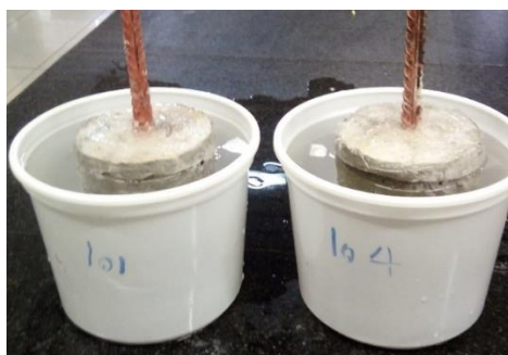
شکل ۲۸-۲- غوطه‌وری نمونه‌های بتنی پیش از انجام آزمون امپدانس به مدت ۳ روز.
