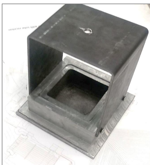
شکل ۴۰-۲- محفظه نگهداری نمونه بتنی در دستگاه نفوذ فشاری یون کلر.
