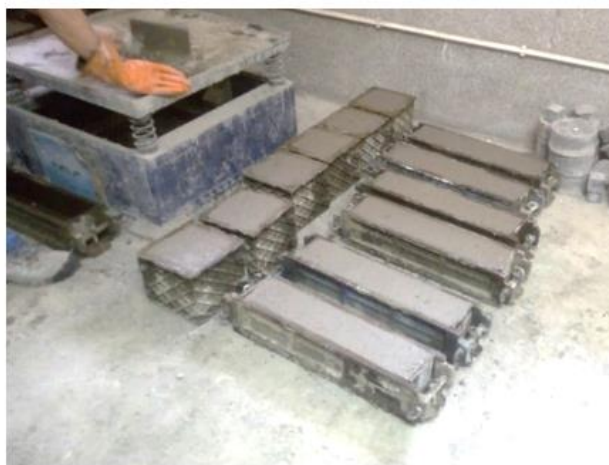
شکل ۲۵-۲- مراحل قالب‌ریزی نمونه‌های بتنی.
