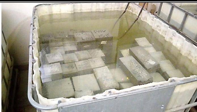
شکل ۲۶-۲- عمل آوری نمونه‌های بتنی در حمام آب و آهک.
