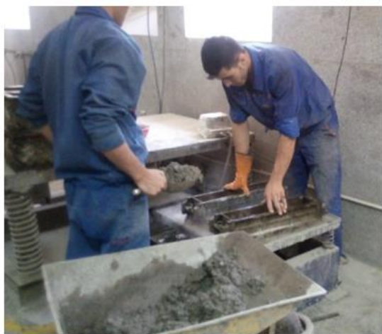
شکل ۲۵-۲- مراحل قالب‌ریزی نمونه‌های بتنی.
