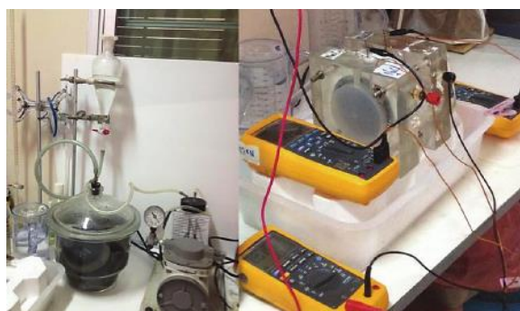
شکل ۳۴-۲- نحوه انجام آزمون تسریع یافته نفوذ یون کلر RCPT
