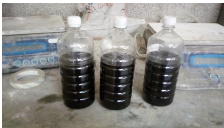
شکل ۲-۲۴- محلول‌های تهیه شده از اکسید گرافن به منظور افزودن در ملات سیمانی.
