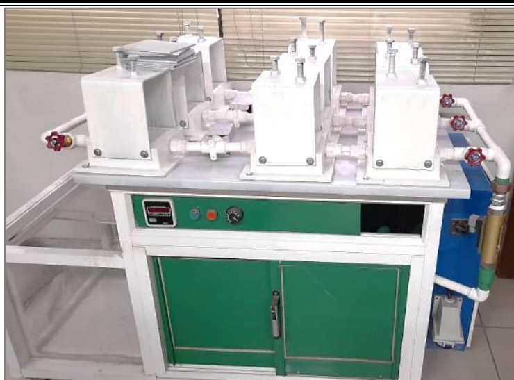
شکل ۴۱-۲- دستگاه ساخته شده برای انجام آزمون نفوذ فشار یون کلر بر روی نمونه‌های بتنی
