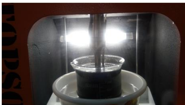
شکل ۲-۲۳- دستگاه آلتراسونیک برای پراکنده‌سازی اکسیدگرافن در آب و ساخت محلول.
