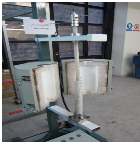
شکل (۵-۲) کوره آزمایشگاهی برای قرار دادن پیل سوختی تک سل در دمای ۸۰۰ درجه سانتیگراد جهت انجام آزمون
