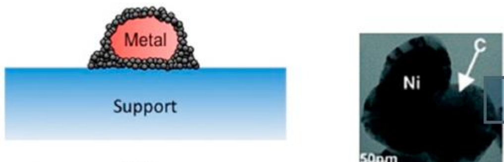
شکل (۴-۱) کپسوله شدن کاتالیست توسط کربن رسوب کرده [۸]
