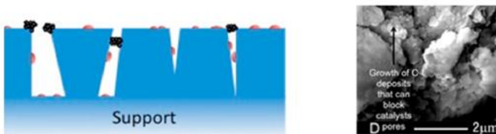
شکل (۵-۱) انسداد مسیرهای عبور واکنش‌دهنده‌ها توسط کربن رسوب کرده [۹]
