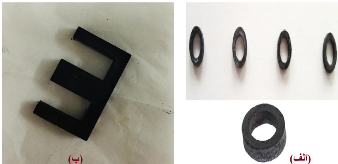
شکل ۵-۵- هسته های ساخته شده از پودرهای تهیه شده (الف) هسته های حلقوی و (ب) هسته E شکل.
