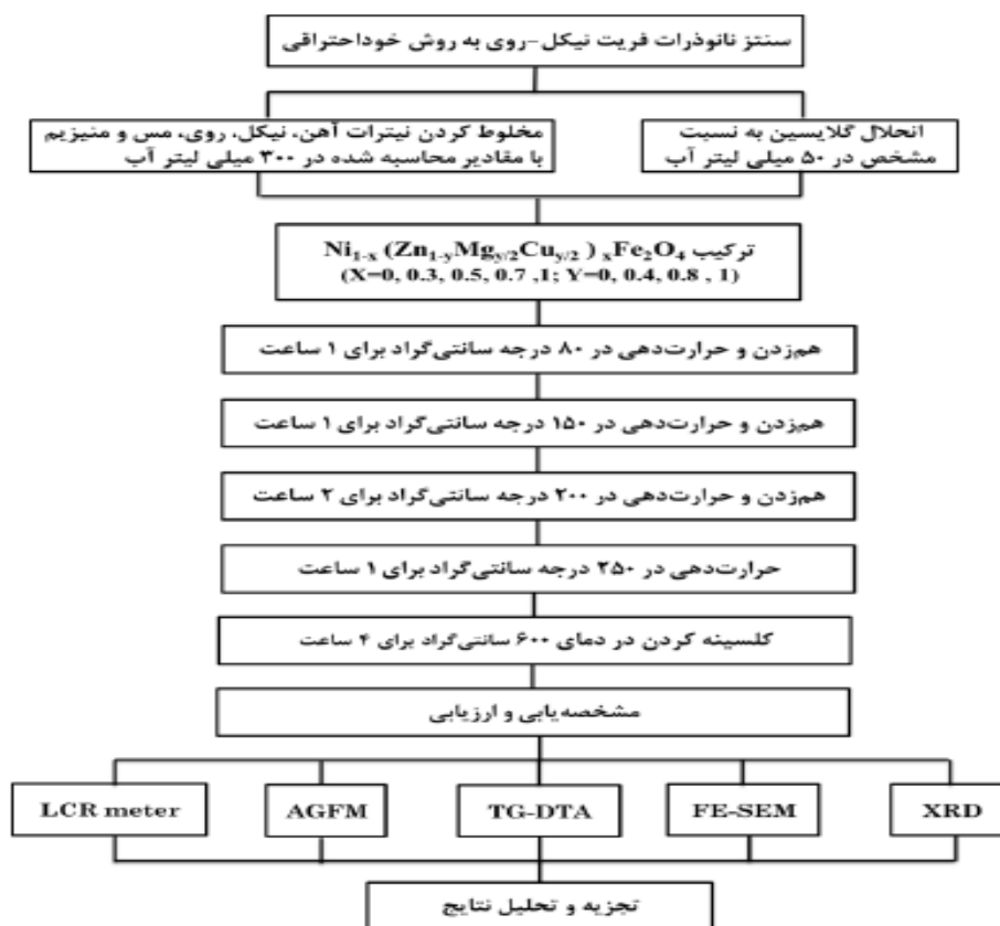
شکل ۳-۱- روندنمای تهیه نانوذرات فریت نیکل روی به روش خوداحتراقی
