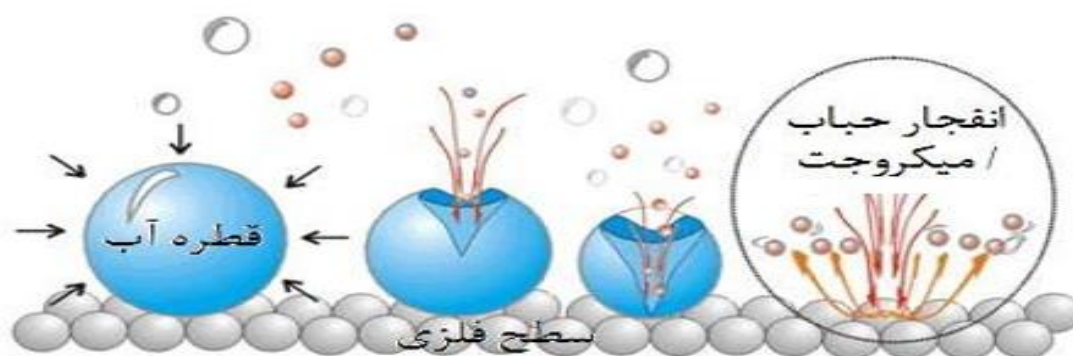
شکل ۱-۷۲- نحوه تشکیل میکروجت در نزدیکی سطوح فلزی.
