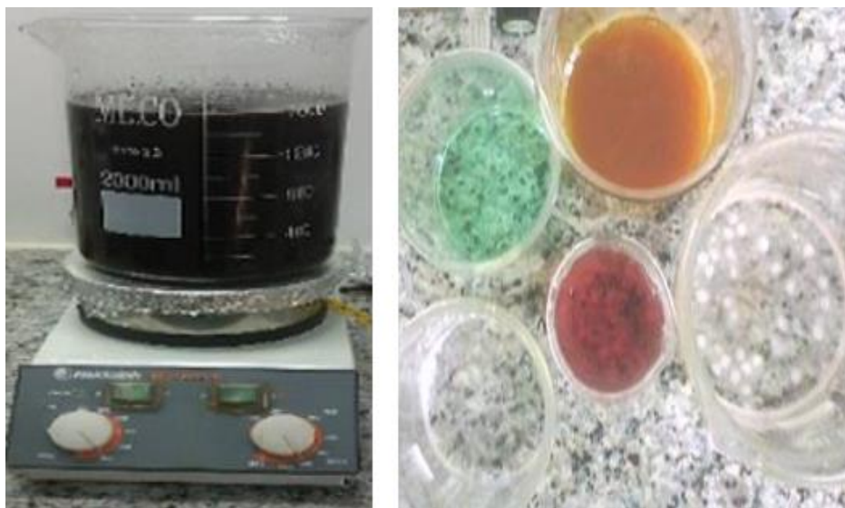
شکل ۲-۱۸- محلول های اولیه و رسوب فریت تشکیل شده.
