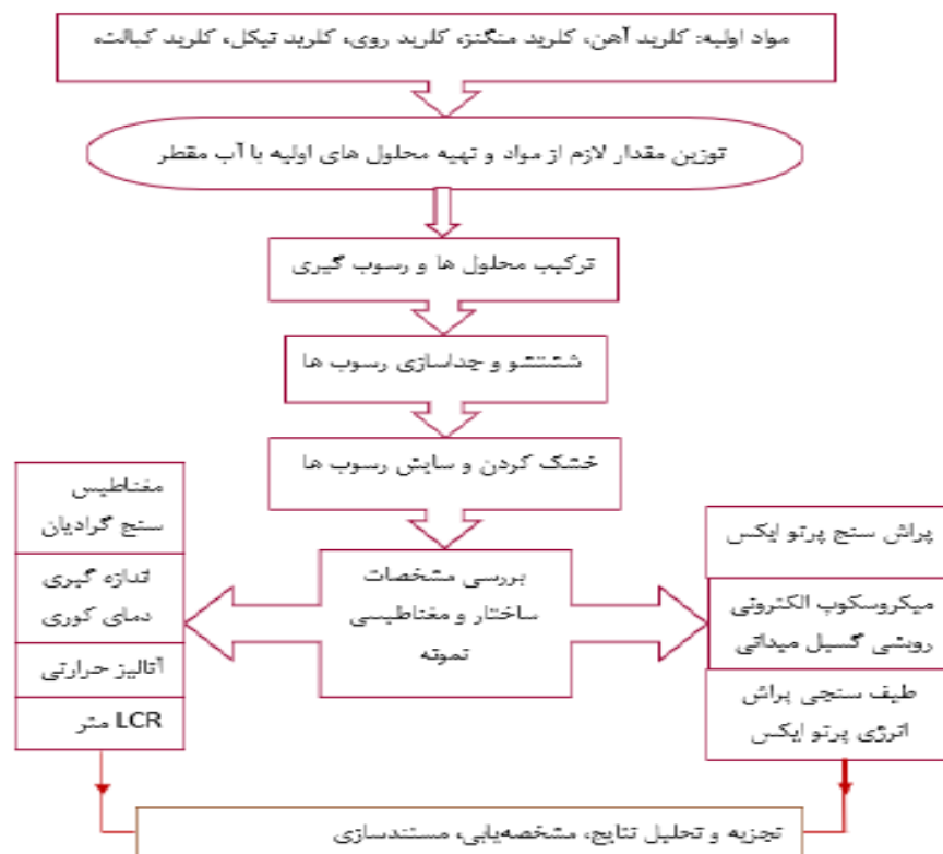
شکل ۲-۱۱- روندنمای تهیه نانوذرات فریت منگنز-روی [۳۷].
