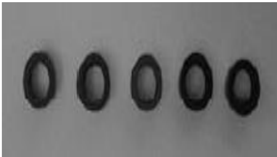
شکل ۲-۱۳- هسته های حلقوی پس از عملیات تفجوشی
