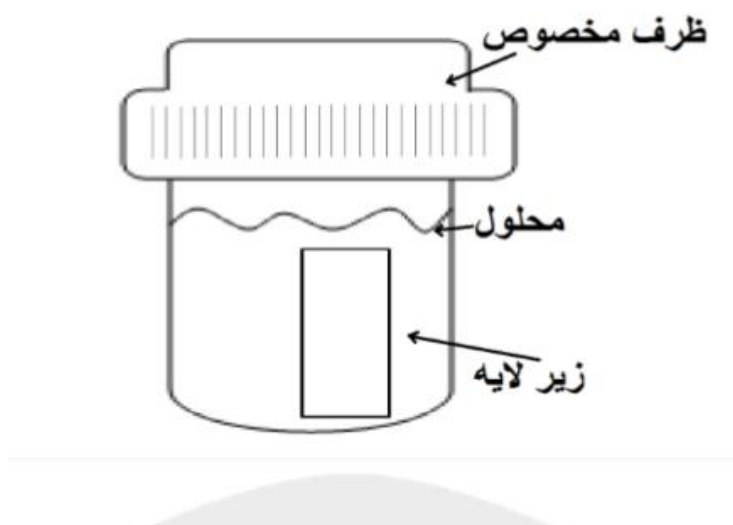
شکل ۱-۶۴- چیدمان وسایل مورد نیاز برای سنتز به روش هیدروترمال [۴۷].
