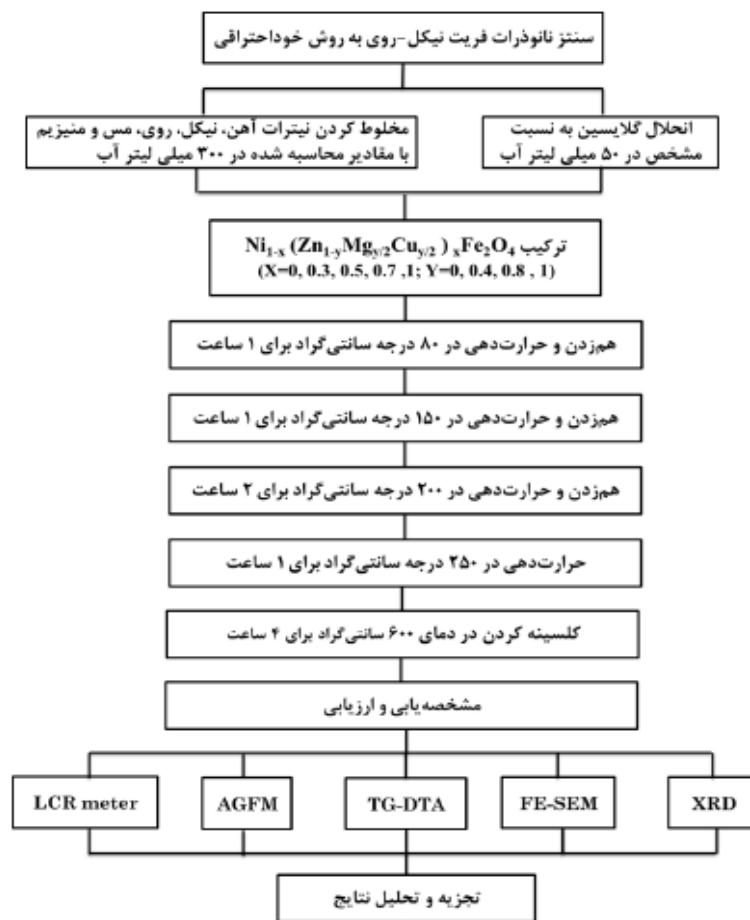
شکل ۲-۱۰- روندنمای تهیه نانوذرات فریت نیکل روی [۳۶].
