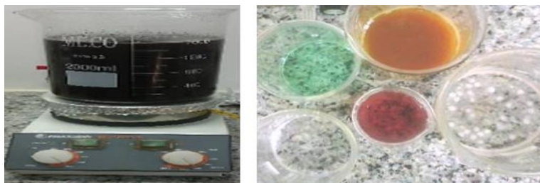
شکل ۳-۲- محلول های اولیه و رسوب فریت تشکیل شده
