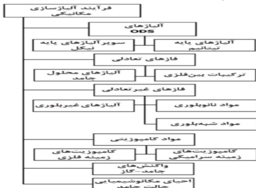
شکل ۶۷-۱- شماتیکی از گستردگی مواد پیشرفته تهیه شده به روش آلیاژسازی مکانیکی [۵۷].
