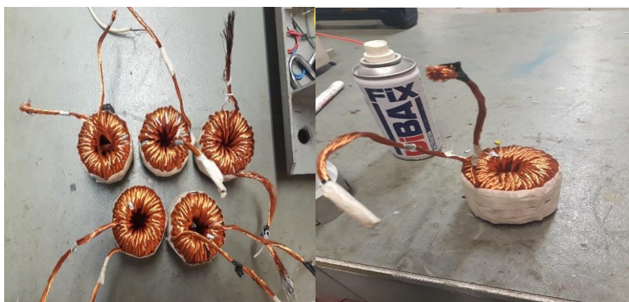
شکل ۲۸-۹- ساخت سلف هسته پود آهن مورد استفاده در چاپر باک
