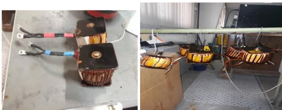
شکل ۲۸-۹- ساخت سلف هسته پود آهن مورد استفاده در چاپر باک
