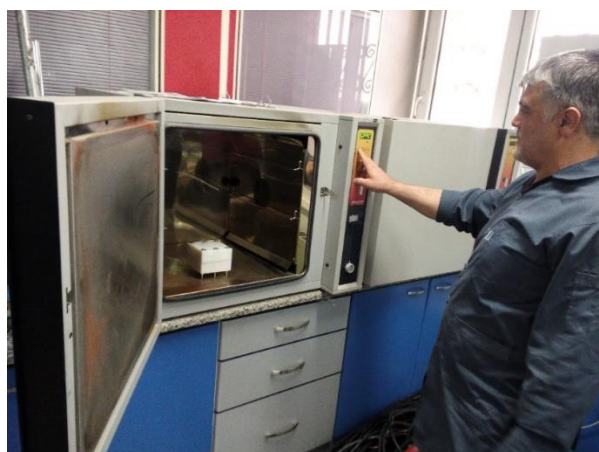
شکل ۱۹-۸- قراردادن قاب در کوره با دمای ۸۰ درجه سانتی گراد
