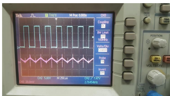
شکل ۲۱-۹- سیگنال خروجی HCPL3120 و جریان مدار H-Bridge
