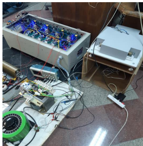
شکل ۱۴-۱۱- تست ورق مغناطیسی M530-50 با استفاده از فریم اپشتین
