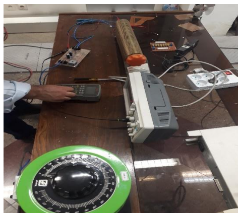
شکل ۷-۹- تست بردهای یکسوساز
