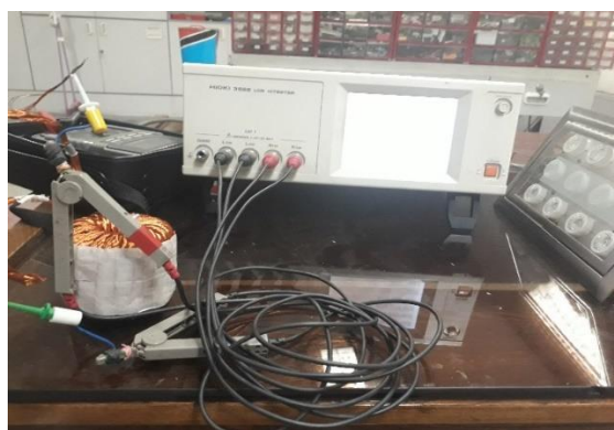
شکل ۳۰-۹- اندازه گیری مقادیر پارامترهای سلف های ساخته شده
