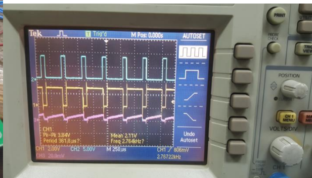
شکل ۲۵-۹- مشاهده سیگنال خروجی MB3759 و پالس اعمالی به گیت ماسفت قدرت و جریان ورودی چاپر
