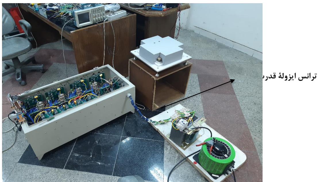
شکل ۵۲-۹- مونتاژ نهایی بخش آمپلی فایر دستگاه B-H متر مبتنی بر اینورتر ۶۳ سطحی CHB نامتقارن
