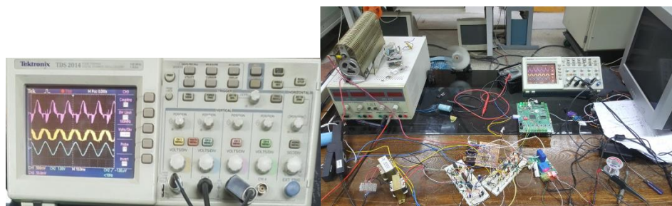
شکل ۱۶-۹- پیاده سازی و تست اولیه مدار کامل اینورتر الف شکل موج ولتاژ و جریان سوئیچ و جریان بار خروجی اینورتر H-Bridge
