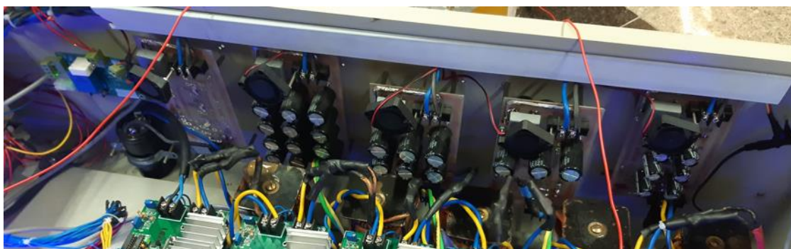
شکل ۱۰-۹- مونتاژ ماژول های یکسوساز داخل کیس دستگاه
