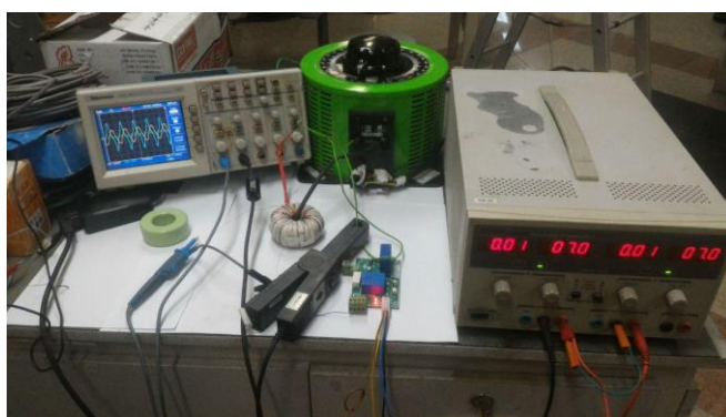
شکل ۸-۳- مدار الکتریکی پیاده شده برای به دست آوردن حلقه B-H
