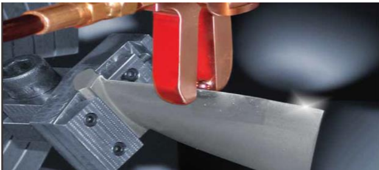
شکل ۳-۲۲: فرایند LPB روی فولاد ضد زنگ پره های مرحله اول کمپرسور توربوفن
