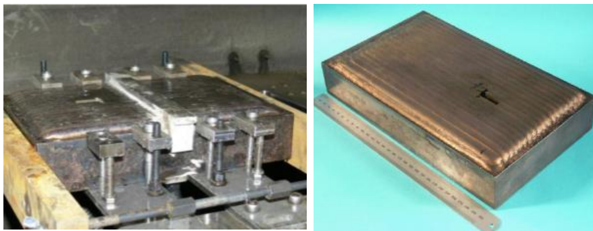
شکل ۱۶-۶: راست: هندسه نمونه لایه نشانی شده چپ: طریقه فیکس کردن برای برش WEDM [۱۰۴]
