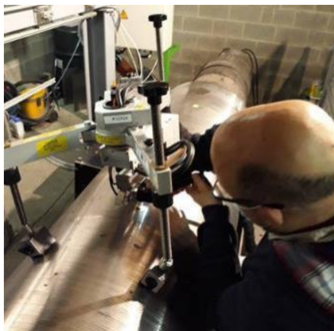
شکل ۷-۱: دستگاه XRD پرتابل برای اندازه‌گیری تنش پسماند در لوله‌ها
