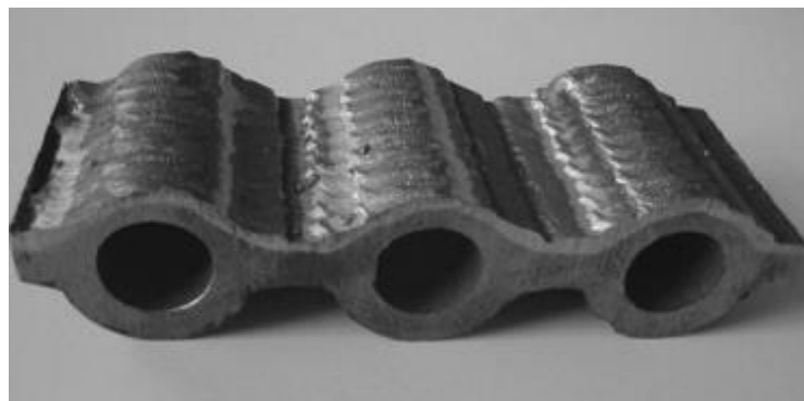
شکل ۵-۲۰: پوشش لوله با فولاد ضد زنگ [۹۳]
