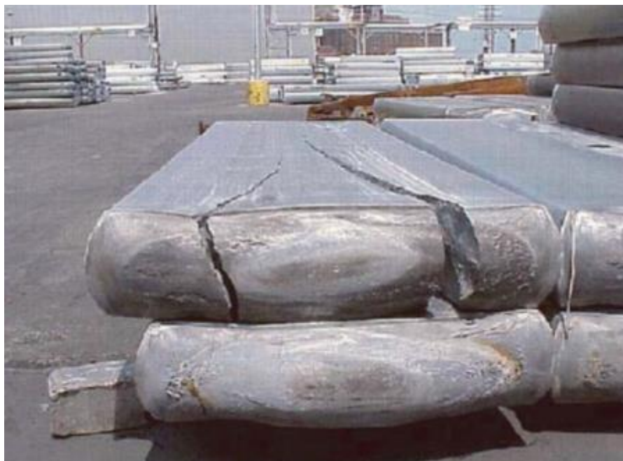
شکل ۱- ۳: شکست در بیل آلومینیوم ریخته‌گری به سبب تنش پسماند [۱]
