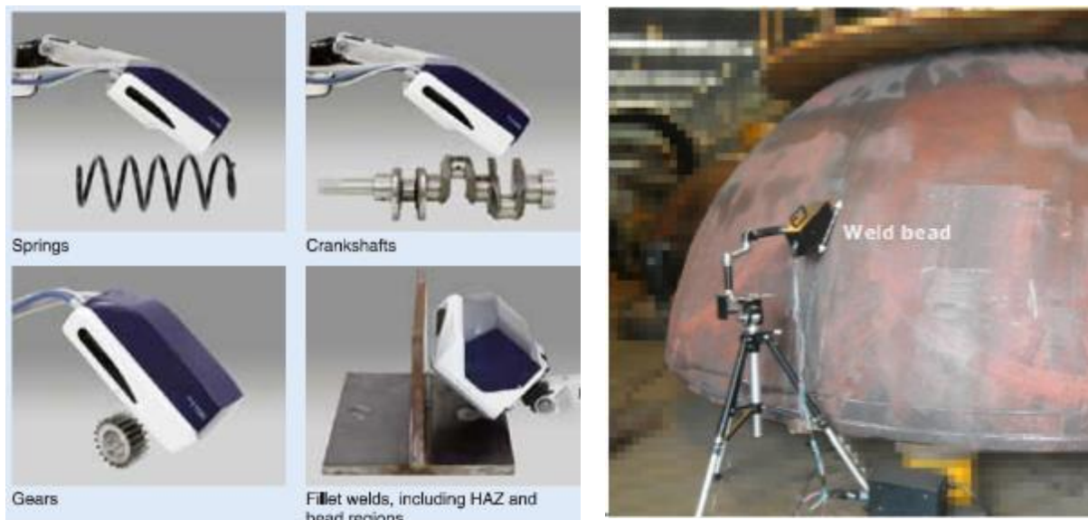
شکل ۷-۳: کاربرد دستگاه پرتابل شرکت PULSTEC در اندازه‌گیری تنش پسماند برای قطعات مختلف
