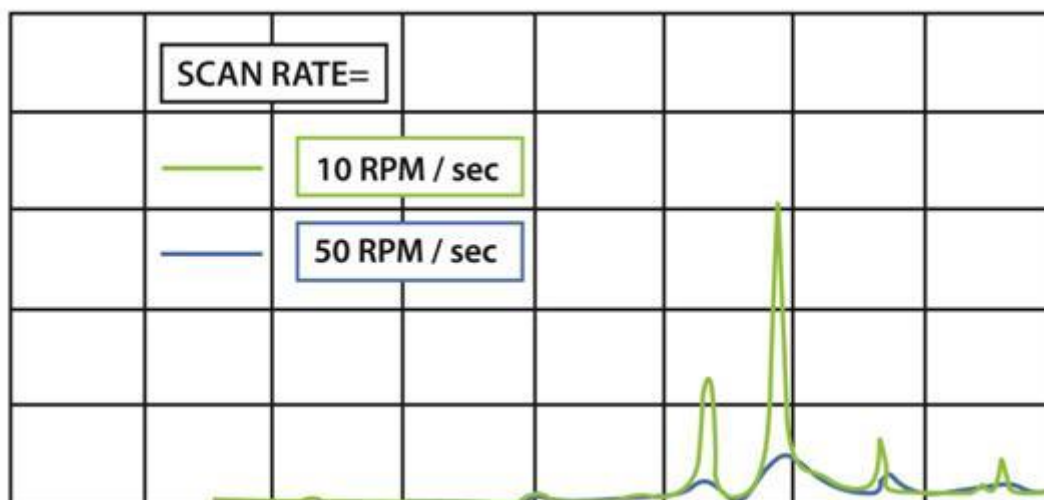
شکل ۴-۸: تأثیر سرعت اسکن بر تشخیص پیکهای رزونانس سازه
