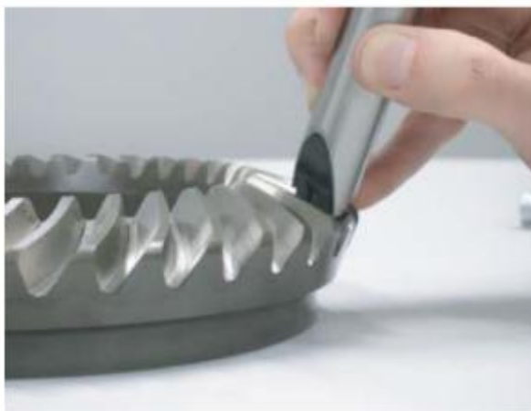
شکل ۳۴-۶: پراب MBN فرکانس بالا، سمت چپ برای سطوح صاف و سمت راست برای سطح چرخنده [۱]
