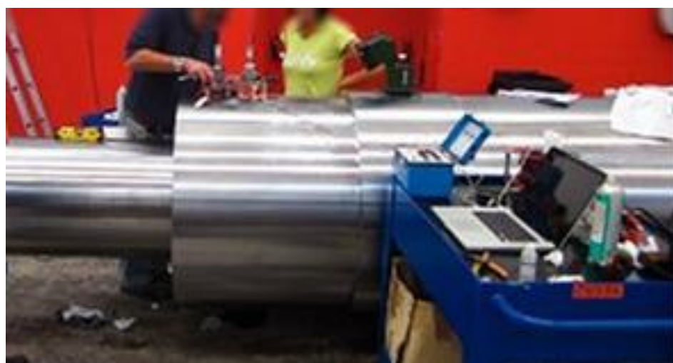
شکل ۳-۸: اندازه‌گیری تنش پسماند در روتور یک واحد نیروگاهی
