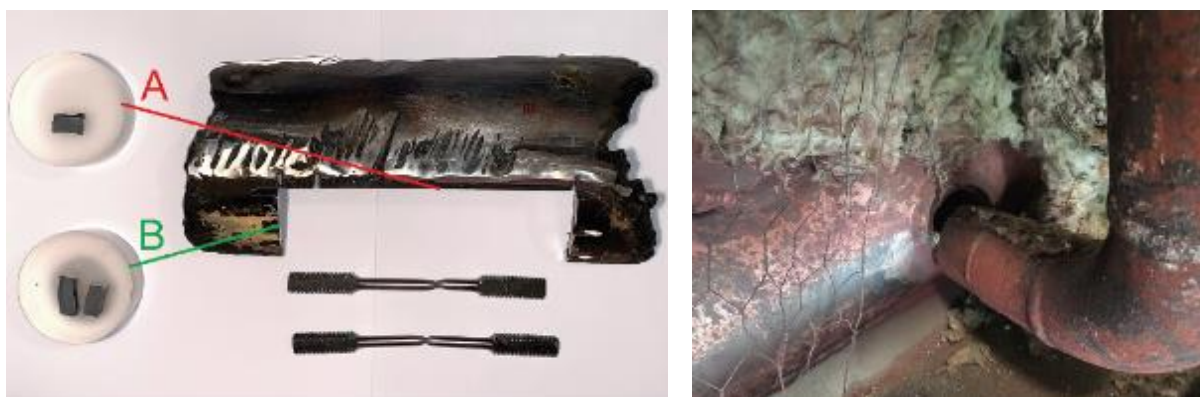
شکل ۲۶-۵: راست: آسیب ایجاد شده در لوله بویلر، سمت چپ: نمونه های بریده شده از لوله آسیب دیده [۹۹]
