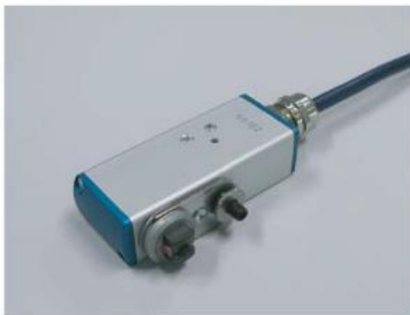
شکل ۳۴-۶: پراب MBN فرکانس بالا، سمت چپ برای سطوح صاف و سمت راست برای سطح چرخنده [۱]
