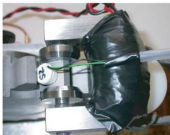
شکل ۳۵-۶: پراب MBN فرکانس پایین، سمت چپ برای سطوح صاف و سمت راست برای سطح چرخنده [۱]
