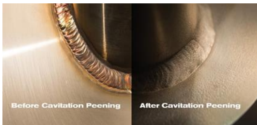
شکل ۳-۳۶: قبل و بعد از اعمال روش Cavitation peening [۴۹]
