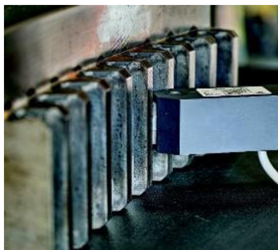
شکل ۷-۱۱: کاربرد دستگاه 3MA micro magnetic برای اندازه‌گیری تنش پسماند
