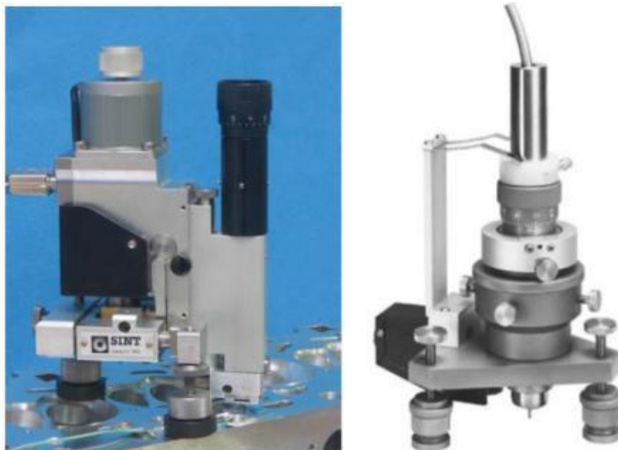
شکل ۲-۱۲: دو نمونه از دستگاه‌های ایجاد سوراخ در روش سوراخکاری مرکزی [۱]
