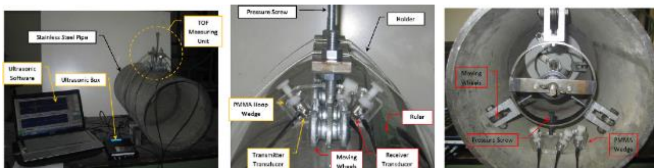
شکل ۷-۱۶: تجهیزات اندازه‌گیری تنش پسماند به روش آلتراسونیک در لوله‌ها، دانشگاه امیرکبیر [۱۲۱]
