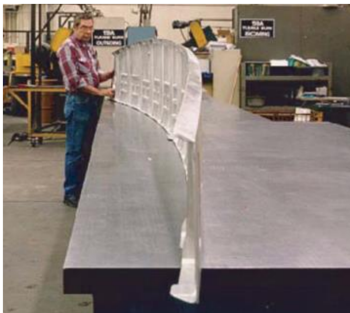
شکل ۱-۴: اعوجاج ایجاد شده در سازه بخش بار یک هواپیما پس از انجام فرایند ماشین‌کاری [۱]
