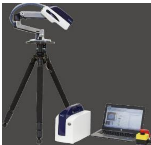
شکل ۷-۲: دستگاه پرتابل X-ray شرکت PULSTEC با نام تجاری \mu -X360
