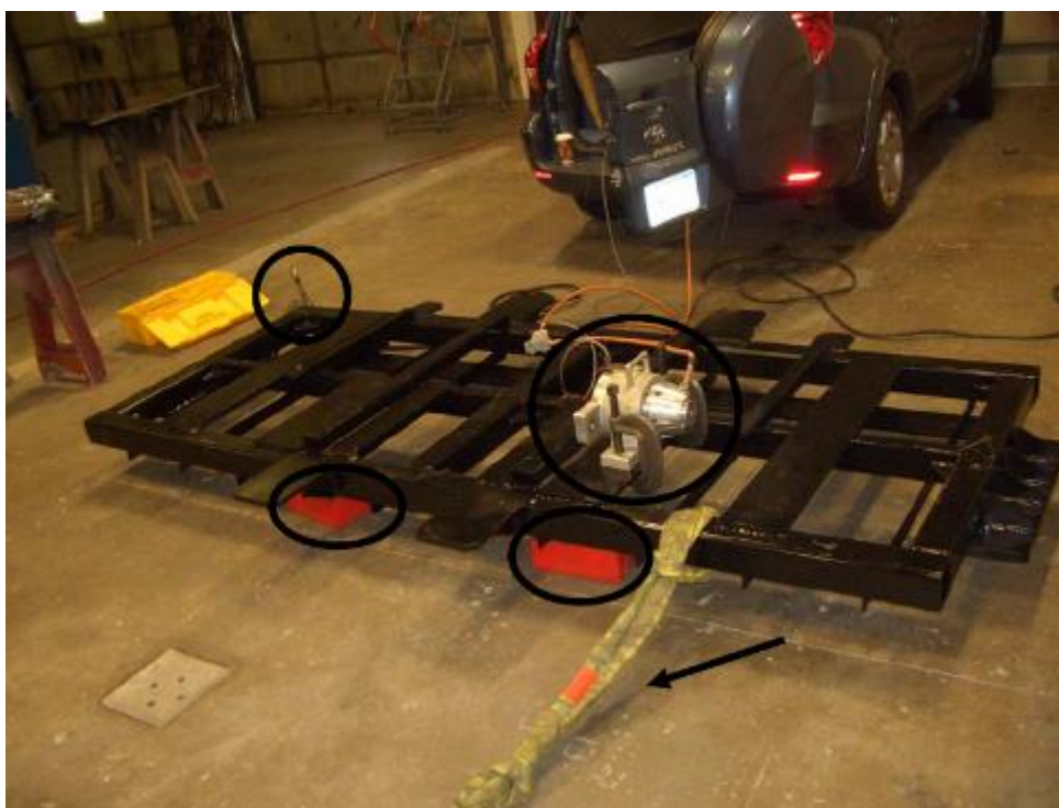
شکل ۴-۱۲: تجهیزات مورد استفاده برای تنش زدایی فریم ۵۰۰ کیلوگرمی
