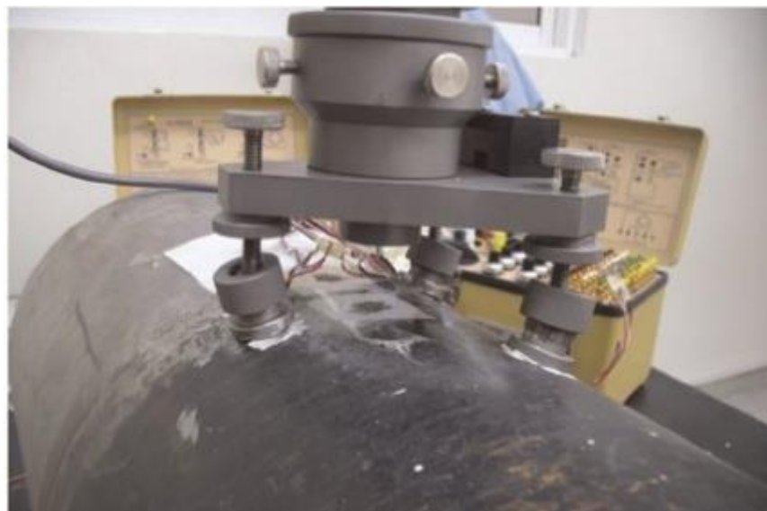
شکل ۴-۸: اندازه‌گیری تنش‌های پسماند در جوش یک لوله با روش سوراخکاری مرکزی
