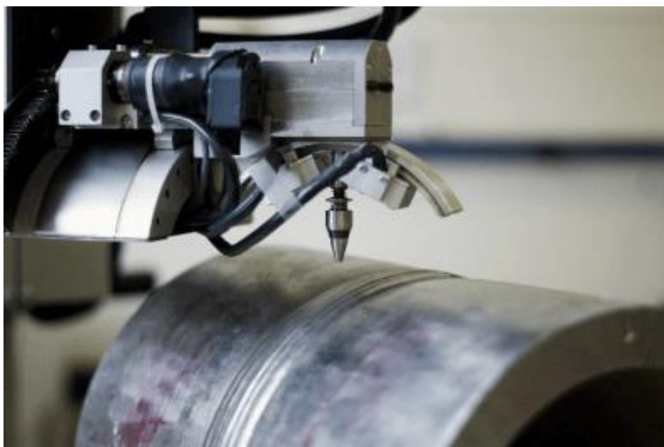
شکل ۲-۲۹: اندازه‌گیری تنش پسماند در جوش یک لوله با استفاده از X-Ray [۱۴]
