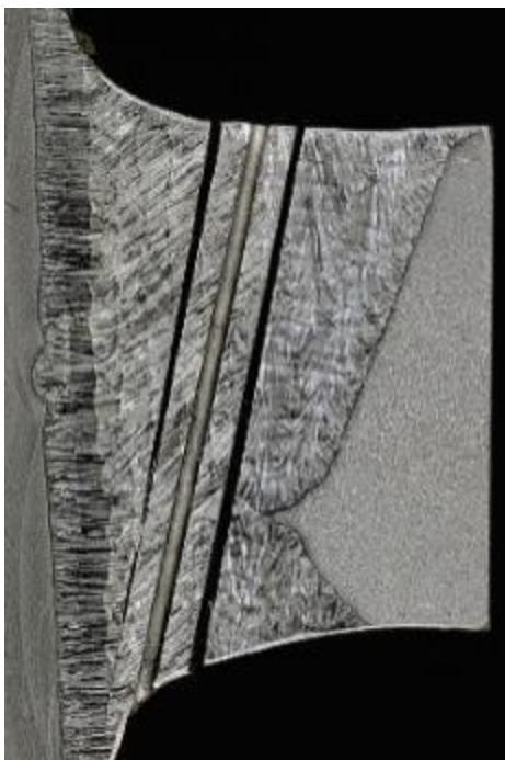
شکل ۲-۱۹: روش سوراخکاری عمیق برای جوش چند پاسه [۵]
