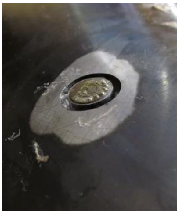
شکل ۷-۹: یک نمونه از برش ایجاد شده روی یک لوله توسط MTS3000-ringcore
