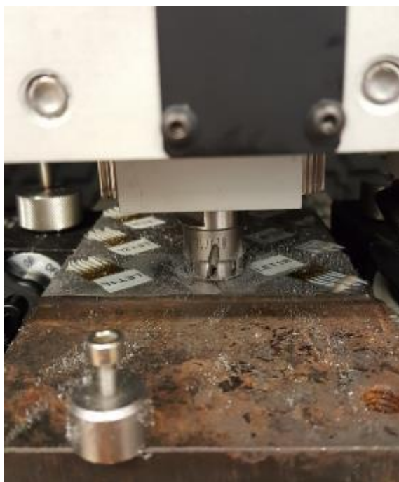
شکل ۷-۹: یک نمونه از برش ایجاد شده روی یک لوله توسط MTS3000-ringcore
