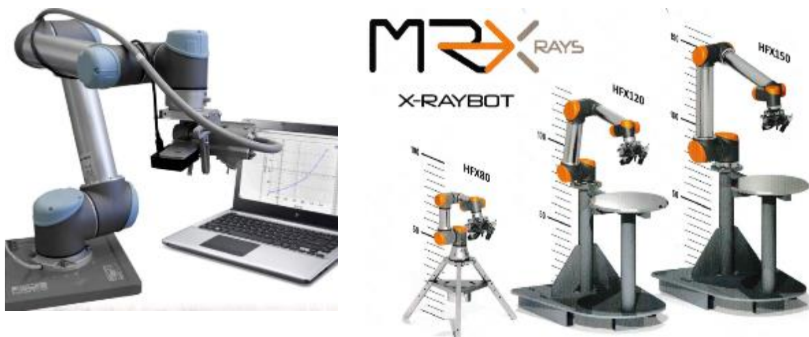
شکل ۴-۷: دستگاه اندازه‌گیری تنش پسماند XRD رباتیک شرکت MRX
