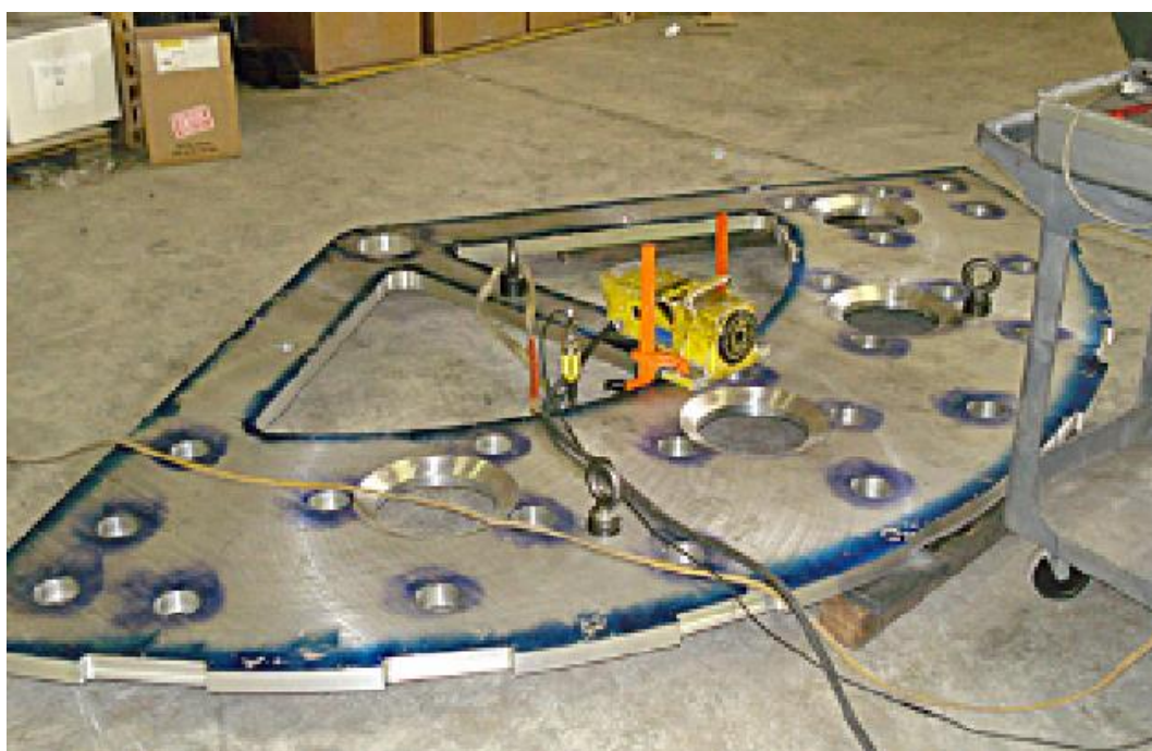
شکل ۴- ۲۱: تنش زدایی ارتعاشی با استفاده از META-LAX
