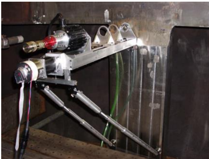
شکل ۲-۲۰: نمونه دستگاه اندازه‌گیری تنش پسماند با روش سوراخکاری عمیق [۵]
