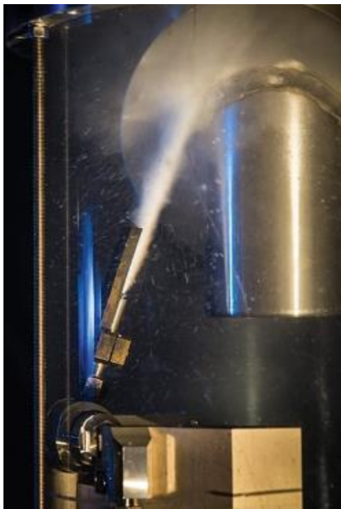
شکل ۳-۳۵: اعمال روش Cavitation peening روی جوش [۴۹]
