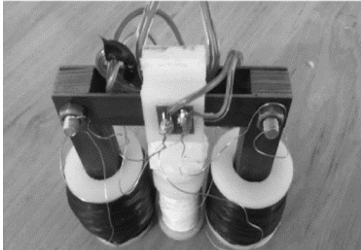
شکل ۷-۱۹: پروب فرسوده و گیرنده ساخته شده برای روش اندازه‌گیری نویز مغناطیسی در دانشگاه زنجان [۱۲۴]
