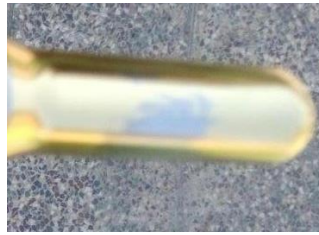
شکل ۲: شکل میکروسکوپی نانو پوشش با عیب جدایش پوشش
