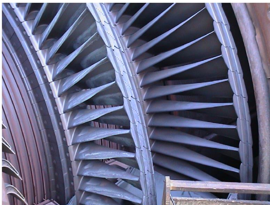
شکل ۱۷-۱. مراحل ۱، ۲ و ۳ توربین گازی نیروگاه منتظر قائم (PG9161E).
