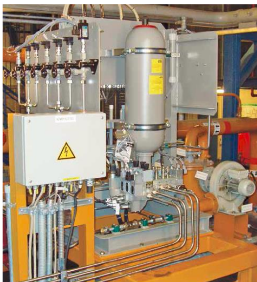
شکل ۱۳-۲. راست: یاتاقان سیستم هیدرولیکی بهینه ساز لقی؛ چپ: اسکید پمپ سیستم هیدرولیکی بهینه ساز لقی
