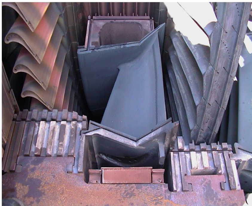
شکل ۱۹-۱. سوراخ های خنک کاری پره های مرحله اول و دوم و نازل مرحله ۲؛ دندانه های کدویی برای چفت شدن
