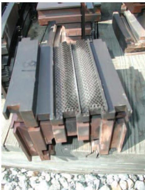
شکل ۱۷-۲. بلاک شراد مرحله ۲ و آب بند هانی کامب روی آن [۲].
