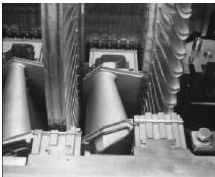
شکل ۱۶-۲. مرحله دوم توربین فریم 9E مجهز به هانی کامب روی شراد و تیغه برنده روی باکت [۲].
