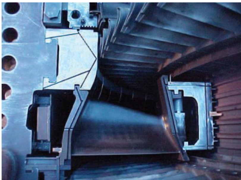
شکل ۲۱-۲ استفاده از آب‌بند بررسی برای آب‌بندی میان مرحله‌ای [۲].
