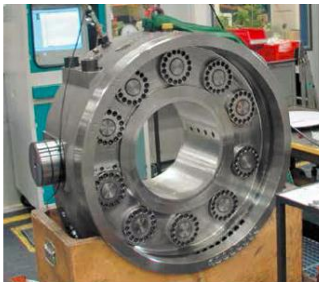
شکل ۱۳-۲. راست: یاتاقان سیستم هیدرولیکی بهینه ساز لقی؛ چپ: اسکید پمپ سیستم هیدرولیکی بهینه ساز لقی
