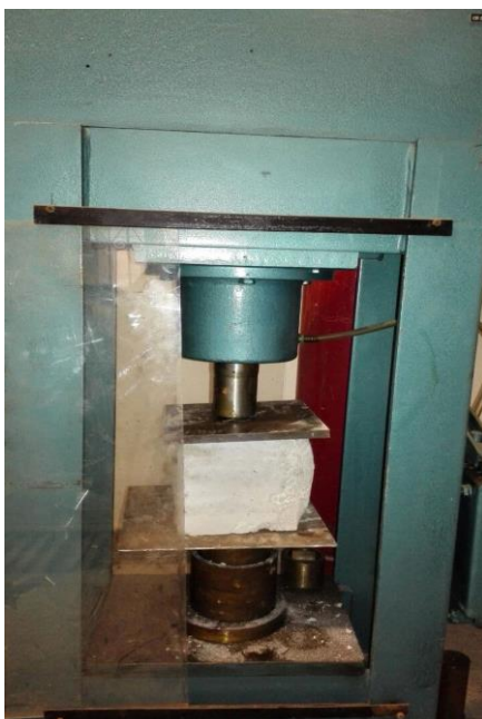
شکل (۳-۷) ایجاد ترک میکرونی توسط دستگاه چک مقاومت فشاری
