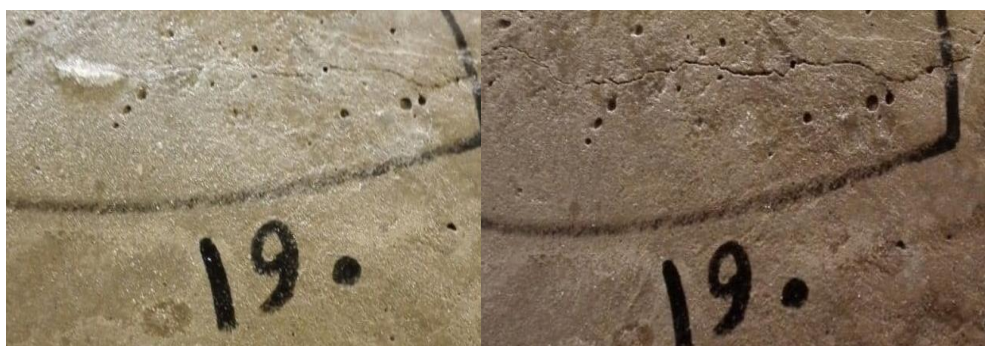
شکل (۳-۱۹) مقایسه خودترمیمی دو نمونه حاوی باکتری ترمیم کننده و نانوسیلیکا. (چپ) نمونه بعد از تیمار ۱۰ روزه داخل آب (راست) نمونه
