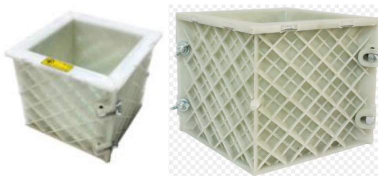
شکل (۲-۱۴) قالب های دوتکه فایبرگلاس
