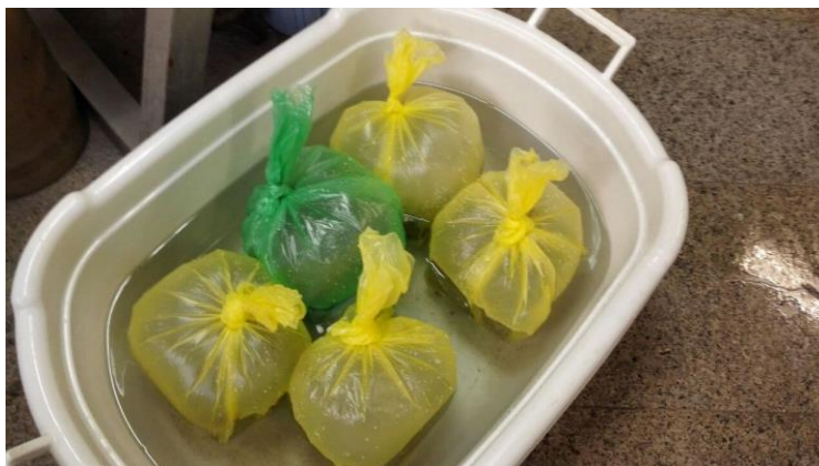
شکل (۳-۱۱) نمونه های بتن حاوی مواد ترمیم کننده زیستی در داخل آب
