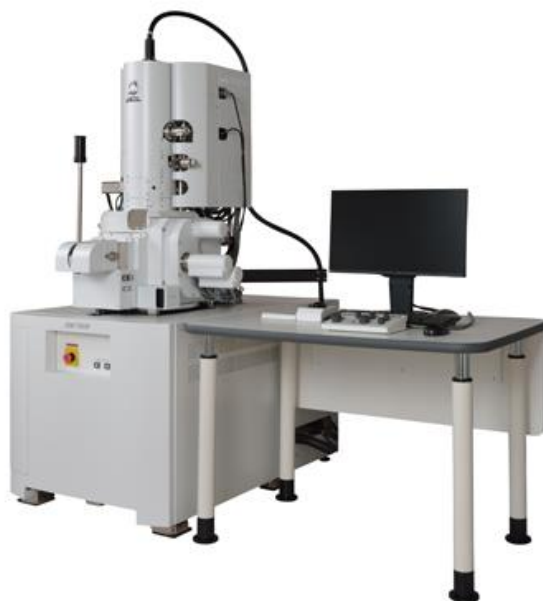
شکل (۲-۲۶) دستگاه SEM [۱۰۲]
