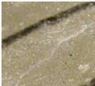
شکل (۳-۱۳) خودترمیمی در نمونه حاوی نانوسیلیکا و باکتری پس از گذشت ۲۰ روز شکل
