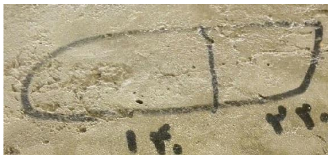
شکل (۳-۱۲) ترمیم ترک های میکرونی درد نمونه های حاوی نانوسیلیکا و باکتری بعد از گذشت ۱۰ روز
