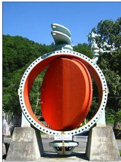
شکل ۲۳-۱. یک شیر پروانه‌ای بزرگ در ژاپن که جهت کنترل جریان ورودی به نیروگاه‌های برق آبی استفاده می‌شود
