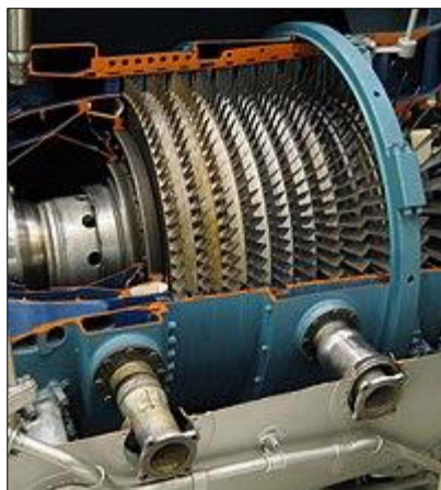
شکل ۱۲-۱. برش مقطعی از کمپرسور فشار بالای موتور TF30
