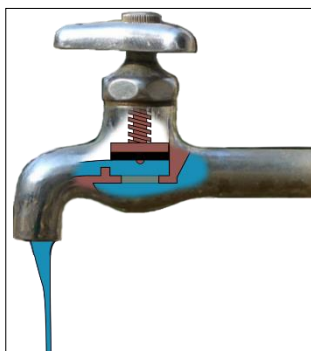
شکل ۱۶-۱. ساختمان داخلی یک شیر آب
