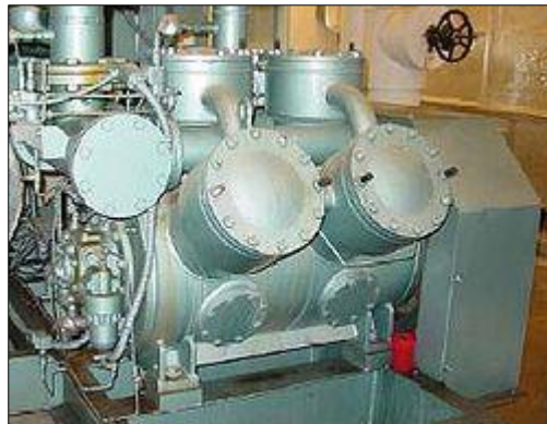
شکل ۱۴-۱. کمپرسور رفت و برگشتی شش سیلندر
