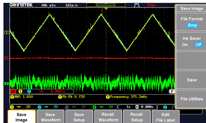
شکل ۱۸-۵: پاسخ سیستم درایو دینامومتر به ورودی مرجع مثلی \pm 800 \text{ rpm} و خطای ردیابی سرعت
