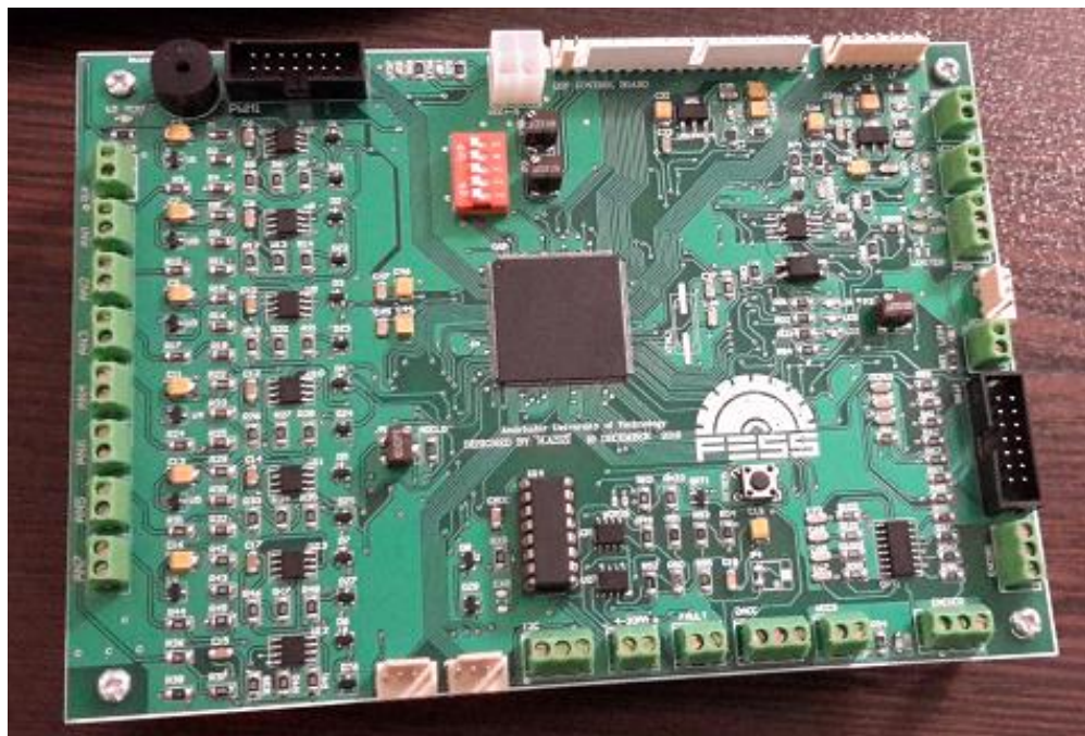
شکل ۲۹-۴: برد تغذیه مدارت فرمان و الکترونیک
