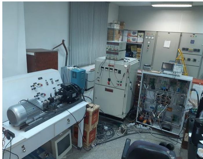
شکل ۵-۲: ست آپ آزمایشگاهی تست سیستم درایو دینامومتر
