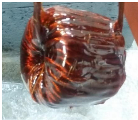
شکل ۱۷-۴: سلف آغشته شده به عایق شارلاک
