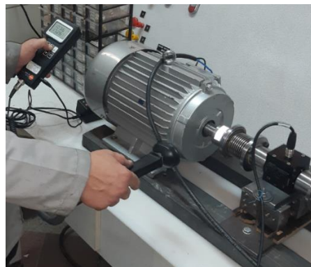
شکل ۷-۷: کالیبراسیون انکودر سرعت با استفاده از سرعت سنج استروبوسکوپ TESTO475
