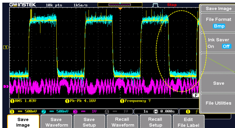
شکل ۲۶-۵: پاسخ گشتاور تولیدی موتور و جریان استاتور به ازای گشتاور مرجع پالسی با \pm 3N.m
