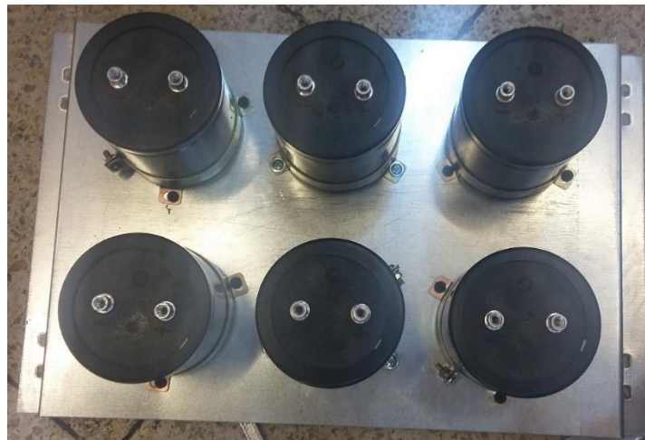
شکل ۸-۴: نصب خازن‌های لینک DC روی ورق فلزی
