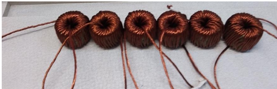
شکل ۱۶-۴: سلف‌های پیچیده شده مورد نیاز برای فیلتر سمت شبکه
