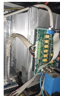
شکل ۲۶-۴: مونتاژ نهایی سیستم خنک سازی شامل هیت سینک و فن تکفاز
