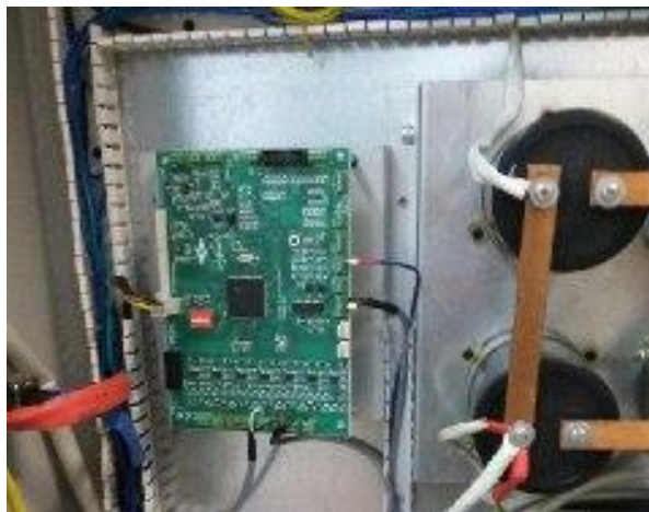
شکل ۳۹-۴: مونتاژ برد DSP در تابلو
