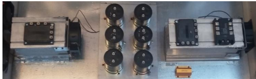
شکل ۲۵-۴: نصب ماژول‌های قدرت روی هیت سینک
