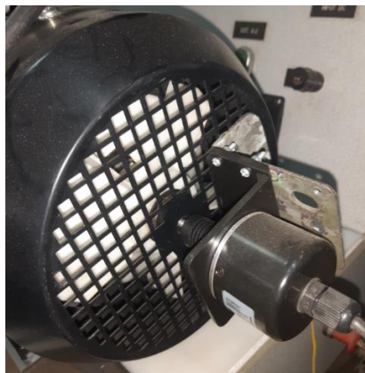
شکل ۳۰-۴: سنسور سرعت نوع انکودر افزایشی نصب شده روی موتور دینامومتر
