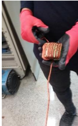
شکل ۱۵-۴: نحوه سیم پیچی سلف
