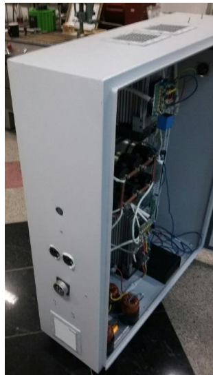
شکل ۴-۳۶: تابلو سیستم دینامومتر از نمای جانبی
