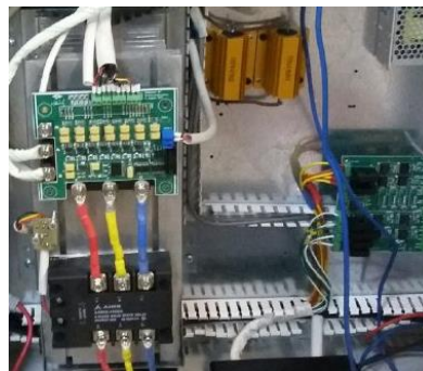
شکل ۴۲-۴: پیاده سازی مازول IPM و سوئیچ حفاظتی SSR
