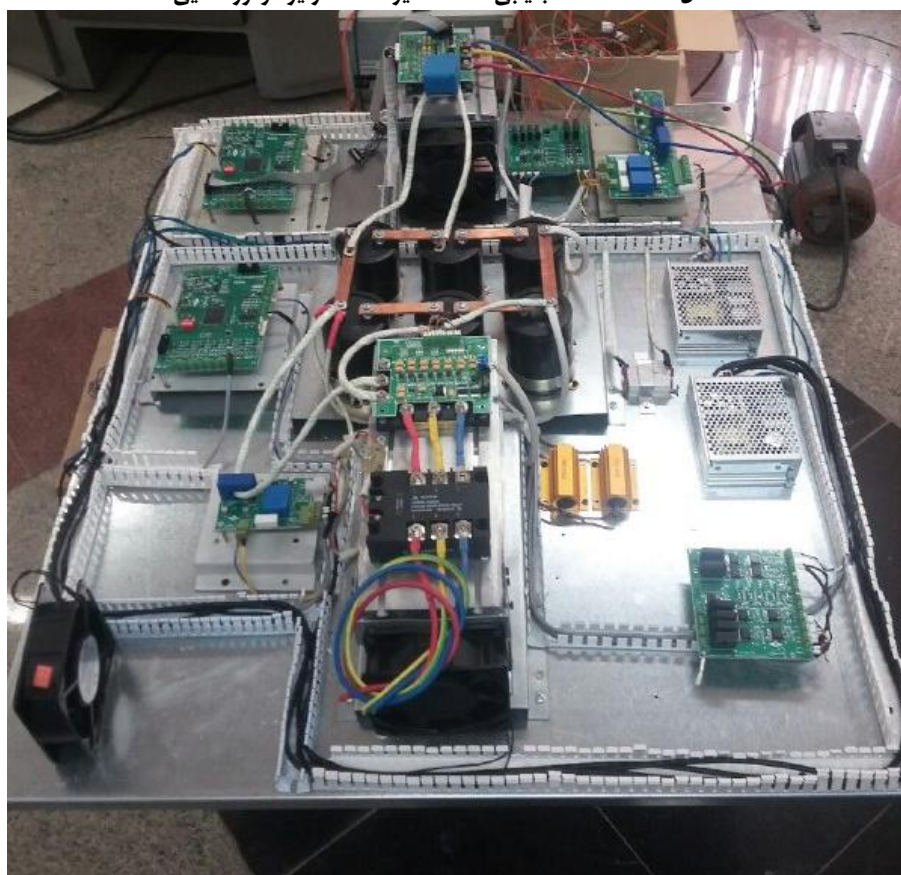
شکل ۳۳-۴: پیاده سازی سیم کشی تابلو سیستم دینامومتر
