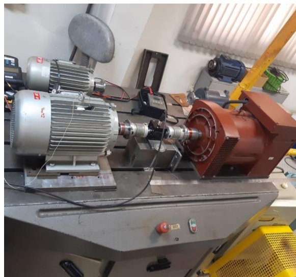
شکل ۶-۸: پیاده سازی سیستم آزمایشگاهی برگذاری روی موتور تحت تست با استفاده از بار ژنراتوری
