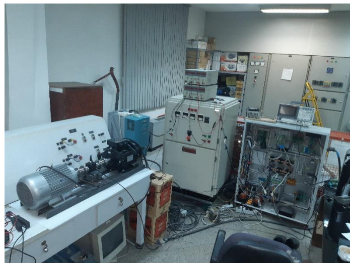
شکل ۶-۱۱. پیاده سازی سیستم آزمایشگاهی بارگذاری روی موتور تحت تست با استفاده از دینامومتر
