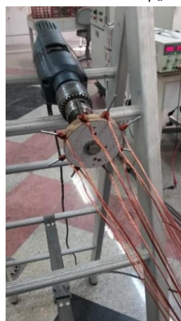
شکل ۱۴-۴: نحوه تابیدن ۸۸ رشته سیم به یکدیگر
