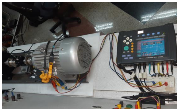
شکل ۷-۸: بازبینی نتایج با استفاده از آنالیزور توان HIOKI1396
