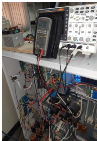
شکل ۵-۷: کالیبراسیون ولتاژ و جریان با استفاده از مولتی متر کالیبره شده PC520M
