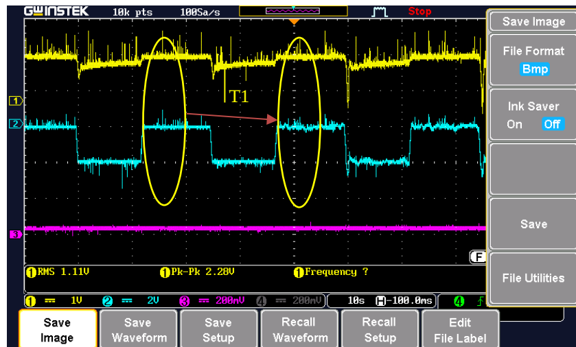
شکل ۵-۵۰: سرعت موتور تحت تست، گشتاور دینامومتر، جریان تزریقی به مقاومت ترمز بار پله ایی \pm 9N.m و اینرسی J_{demand}=0.5* J_{dynamo}
