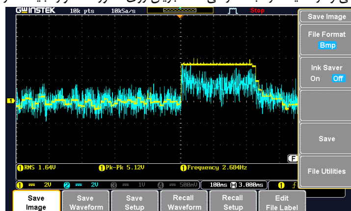
شکل ۵-۸: جریان مرجع روی محور q و جریان اندازه گیری روی محور q موتور دینامومتر در پاسخ به ورودی پله
