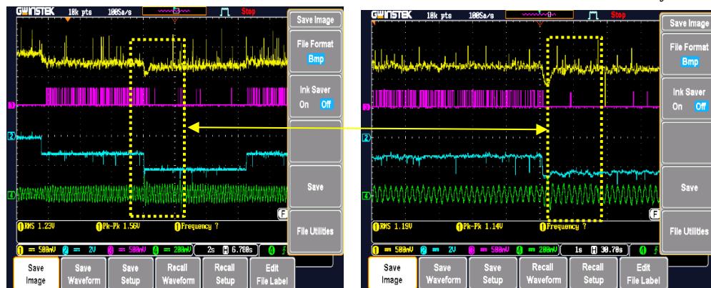
شکل ۴۹-۵: سرعت موتور تحت تست، گشتاور دینامومتر، جریان تزریقی به مقاومت ترمز، جریان موتور تحت تست به ازای گشتاور بار
