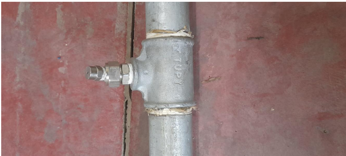
شکل (۳-۳): نمایی از نازل‌های مورد استفاده در سیستم شستشوی آزمایشگاهی
