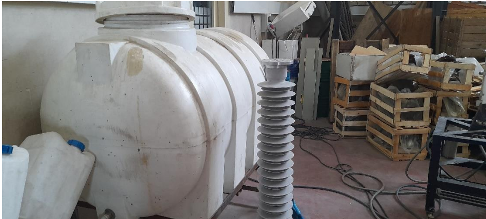
شکل (۳-۶): نمایی از منبع آب مورد استفاده در سیستم شستشوی آزمایشگاهی
