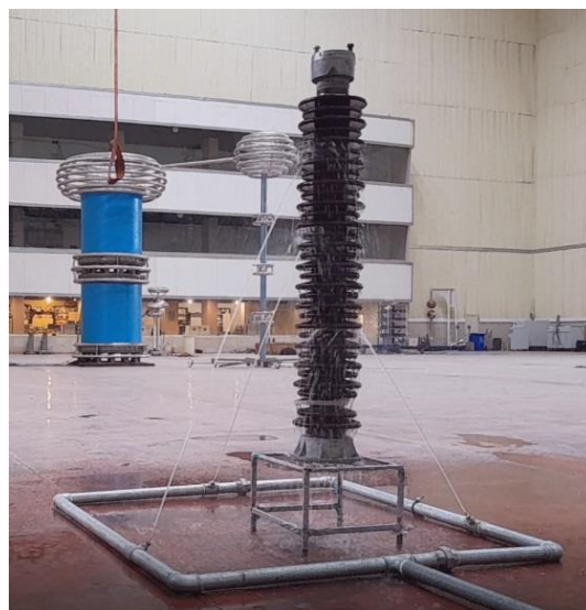
شکل (۳-۹): نمایی از پاشش مناسب آب از نازل‌ها به سطح مفره با انجام هواگیری در سیستم پمپاژ
