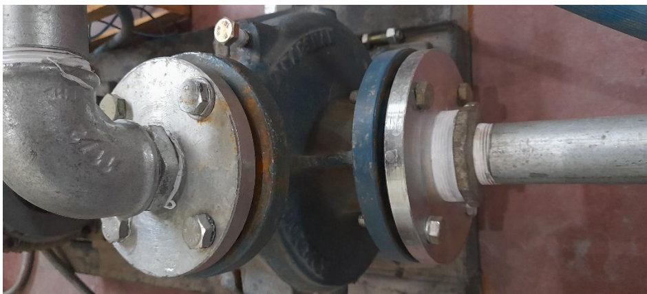
شکل (۳-۵): نمایی از فلنج‌های ورودی و خروجی مورد استفاده در سیستم شستشوی آزمایشگاهی
