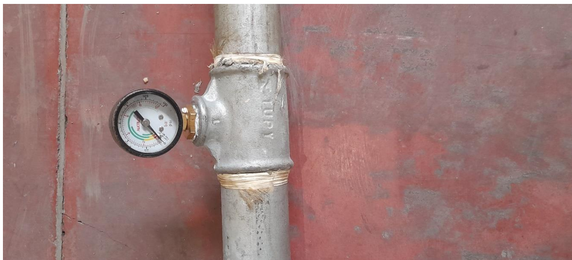
شکل (۲-۳): نمایی از گیج فشار مورد استفاده در سیستم شستشوی آزمایشگاهی
