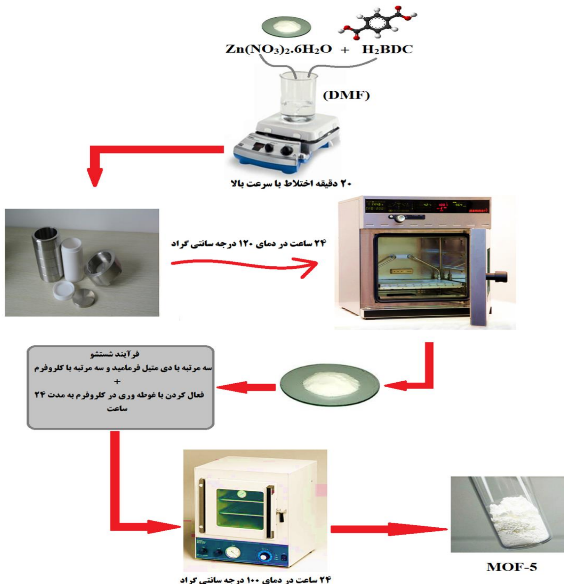
شکل ۱-۲- شماتیک مراحل سنتز سولوترمال نمونه های MOF-5 در این پژوهش.
