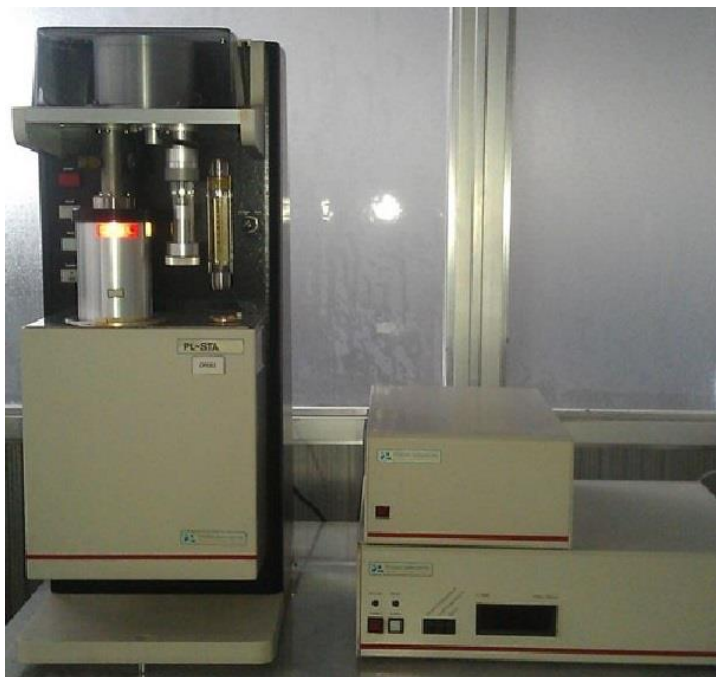
شکل ۳-۲- دستگاه آنالیز وزن سنجی حرارتی (TGA).
