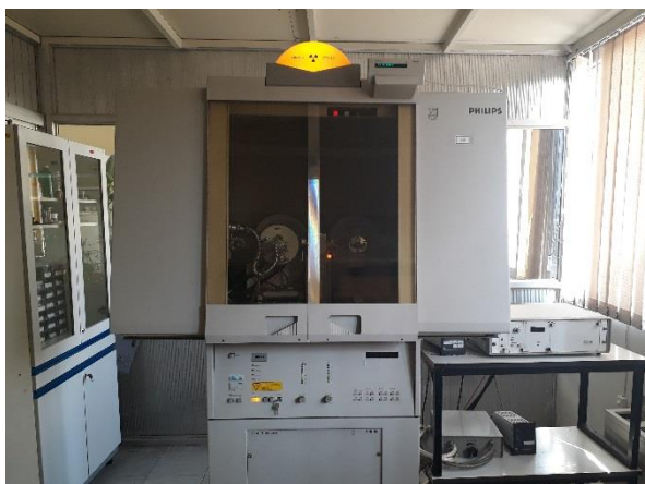
شکل ۱-۲- دستگاه آنالیز پراش اشعه ایکس (XRD).
