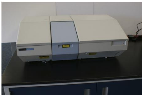
شکل ۲-۲- دستگاه طیفسنجی مادون قرمز (FTIR).
