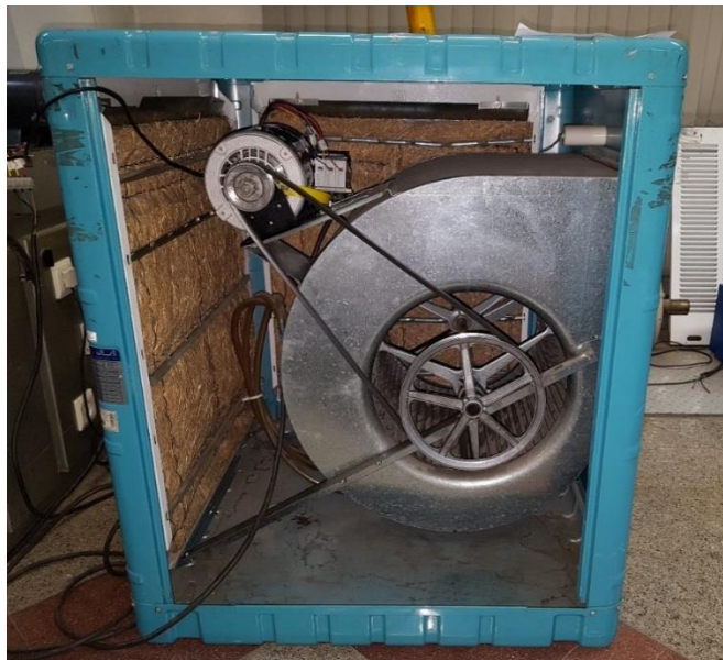
شکل ۱۷-۵: سیستم آزمایشگاهی تست موتور سنکرون رلوکتانسی با آهنربای کمکی بر روی کولر آبی
