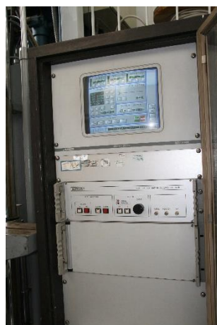
شکل ۲-۵: دستگاه کشش یونیورسال جهت کالیبره نمودن سلول های بار
