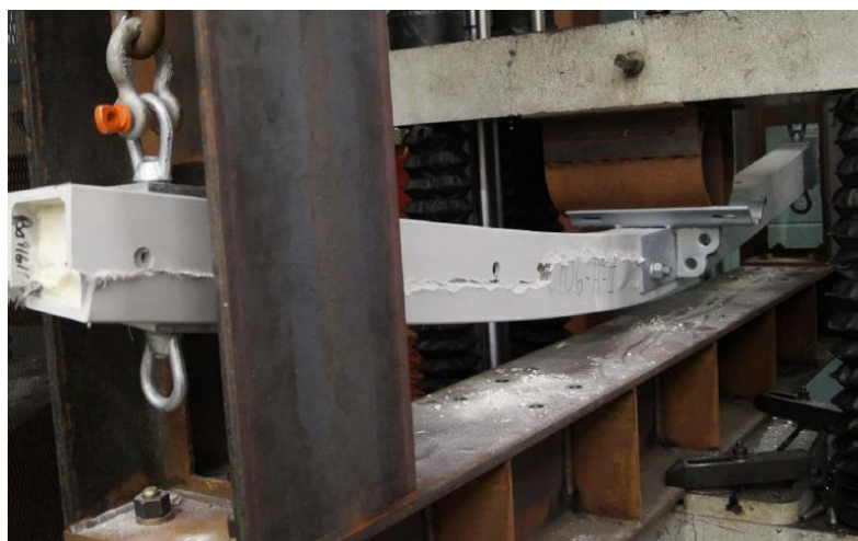
شکل ۲-۴۳ نمای آزمون سه نقطه‌ای، پس از انجام آزمون و گسیختگی طولی
