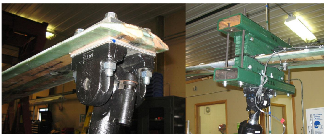
شکل ۳-۱۱. دو روش متفاوت اتصال عملگر به پره توربین بادی، سمت راست روش اتصال زینی، و سمت چپ روش اتصال مستقیم
