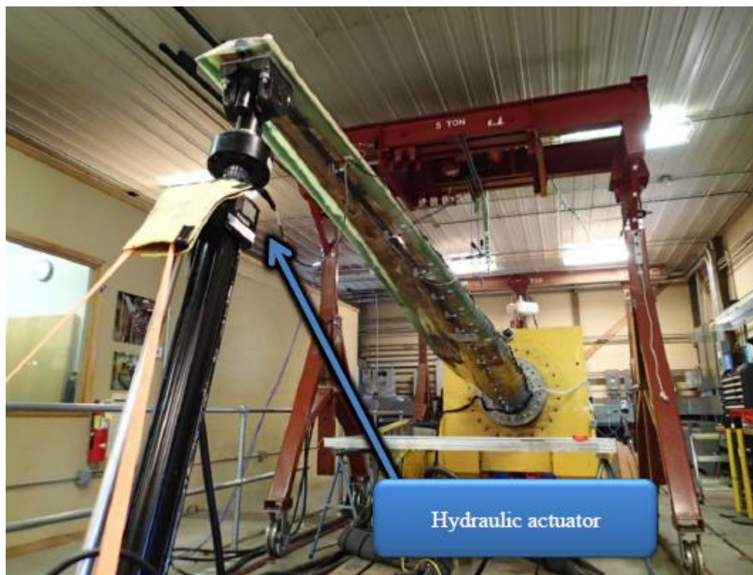
شکل ۳-۱۰. نمای کلی از برپایی پره توربین بادی جهت انجام آزمون لنگر با اعمال نیرو توسط عملگر هیدرولیک در انتهای پره
