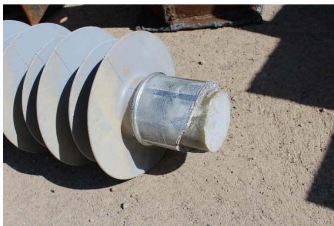
شکل ۵-۶ آزمون مکانیکال مقره‌های انتقال نیرو
