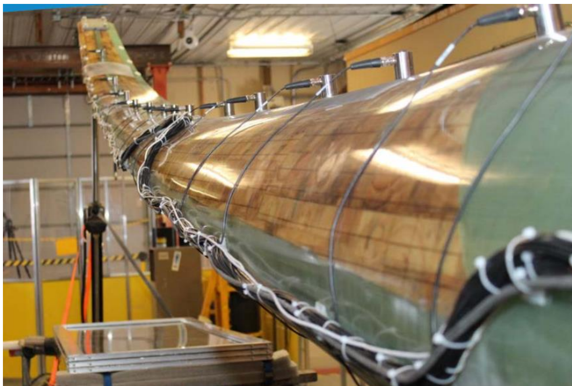
شکل ۳-۵. استفاده از حسگرهای انتشار صوتی نصب شده بر روی پره توربین بادی
