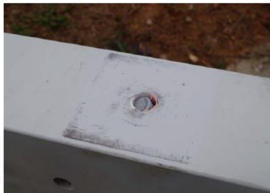
شکل ۲-۵۰ شکست یراق در آزمون بار قائم و جانبی کراس آرم
