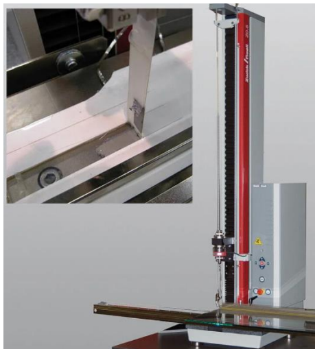
شکل ۳-۱۸. شامل آزمون مقاومت در مقابل پوسته شدن فیلم تدلار، [۱۴۵]
