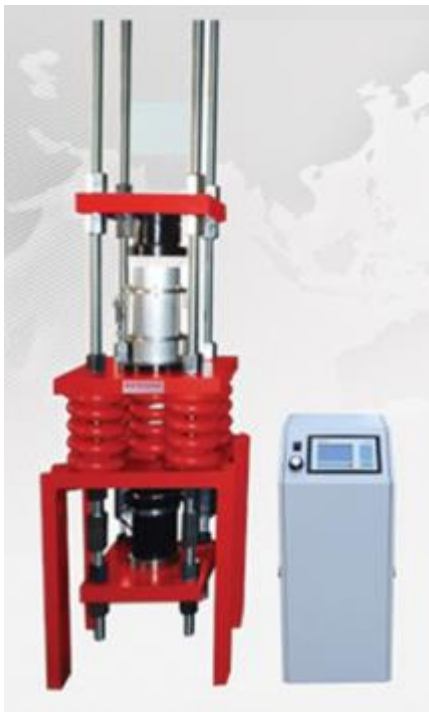
شکل ۴- ۲۸ دستگاه آزمایش خزش بلند مدت مطابق با استاندارد ASTM E139، [۱۵۸]
