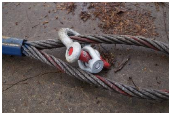
شکل ۲-۵۰ شکست یراق در آزمون بار قائم و جانبی کراس آرم
