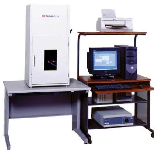
شکل ۴-۳ ابعاد دستگاه آزمون خستگی التراسونیک ، [۱۵۱]
