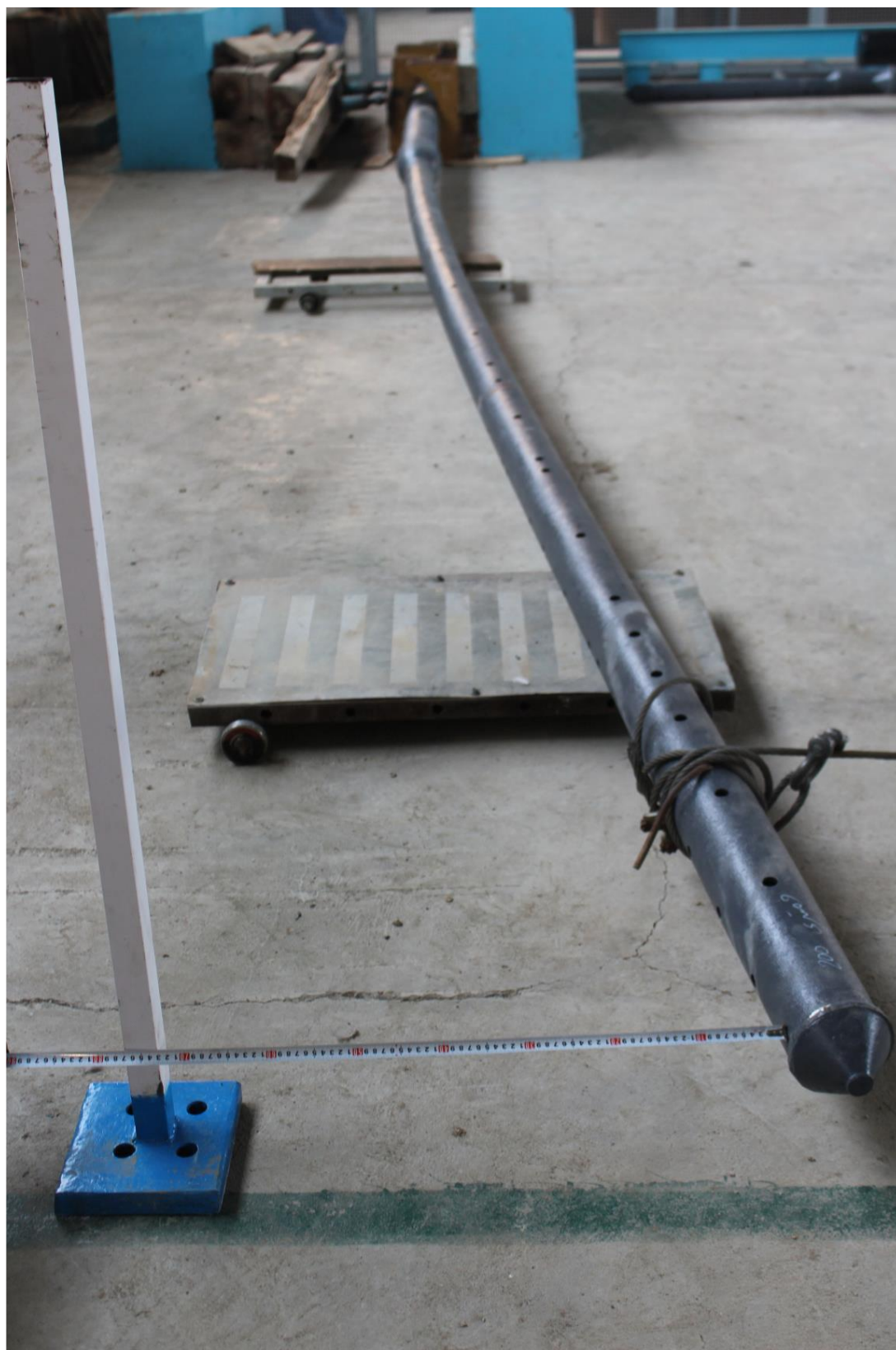
شکل ۴-۶ پایه ۱۲ متری توزیع نیرو چدنی
