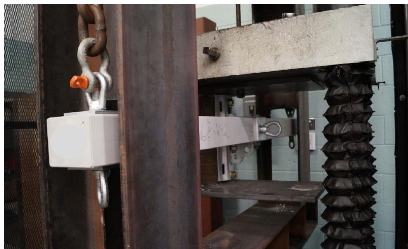
شکل ۲-۴۲ نمای برپایی آزمون سه نقطه‌ای، پیش از انجام آزمون
