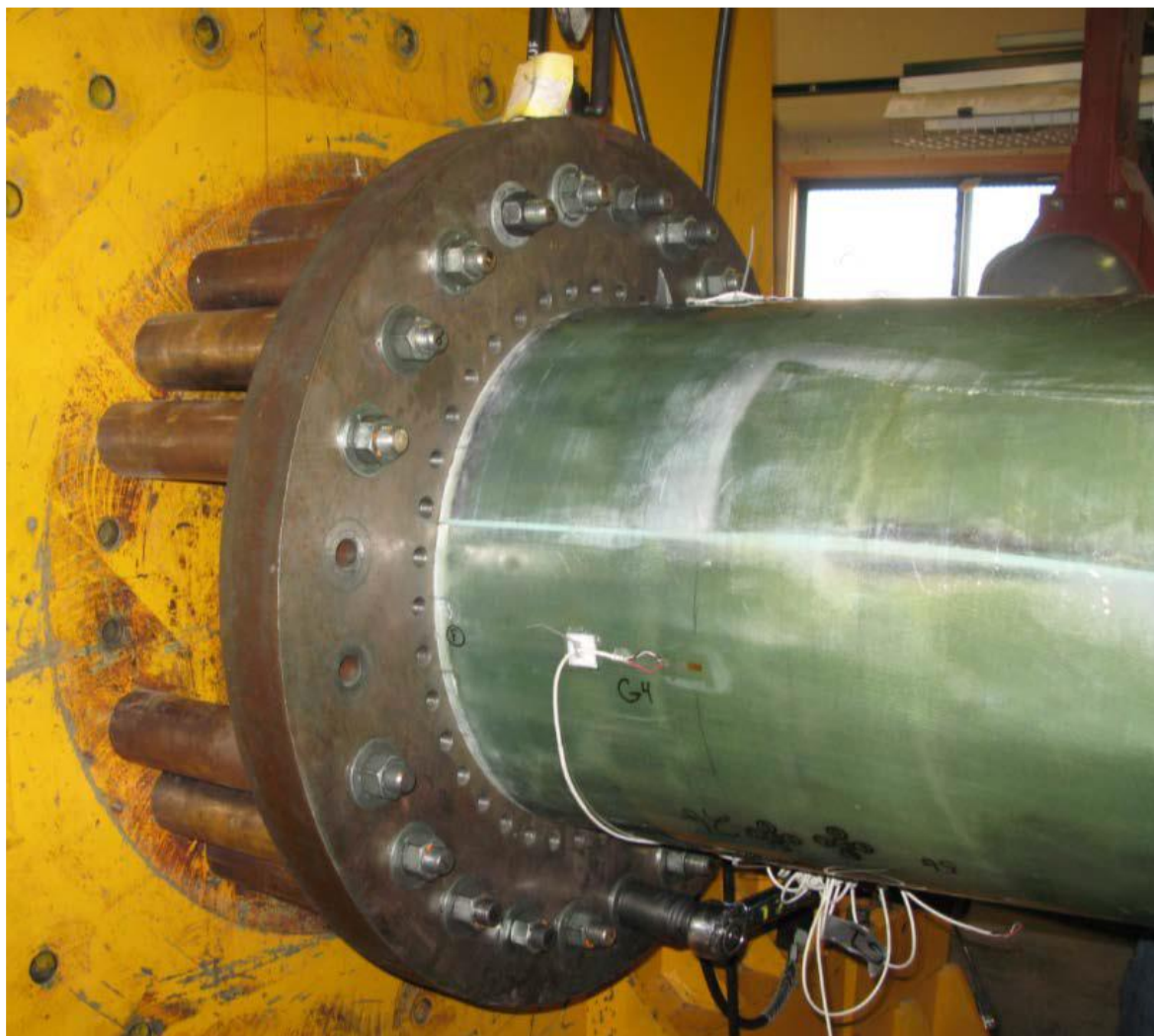
شکل ۳-۹. رابط اتصال پره توربین بادی به گیرگاه با زاویه متغیر و نمایش اتصال کرنش سنج بر روی پره توربین بادی
