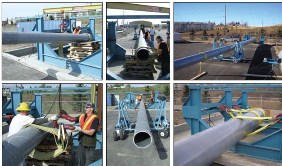
شکل ۲-۵۷ نحوه مهار پایه کامپوزیت در قاب فولادی با کمک بندهای بافته شده، و تعبیه گاری برای راس پایه، [۱۴۳]
