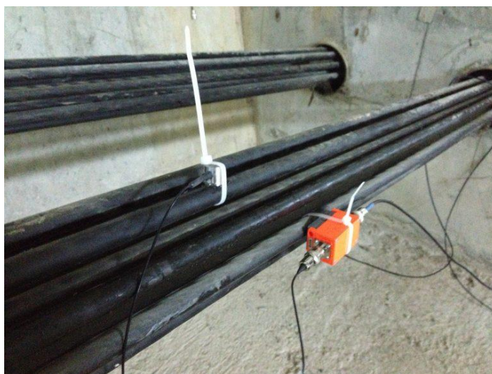
شکل 35-4 استفاده از حسگرهای مبتنی بر انتشار آکوستیک بر روی کابل‌های پست‌نیدگی، [۲۰]
