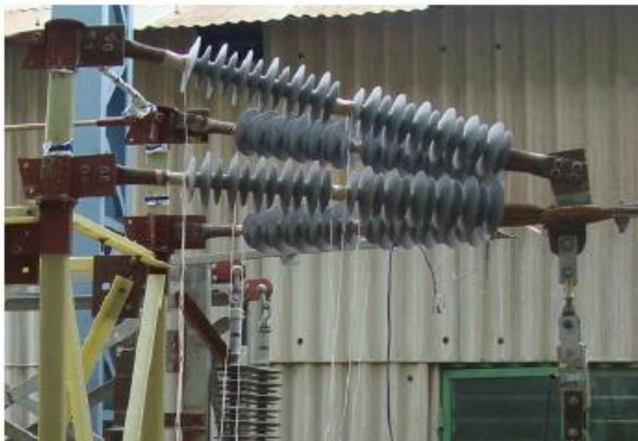
شکل ۲-۴۰ عکس بازو تحت آزمایش مکانیکی [۱۳۶].
