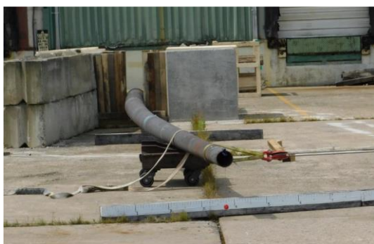
شکل ۲-۵۵ استفاده از گیرگاه بتنی و قراردادی الوار جهت مهار پایه توزیع، [۱۴۱]
