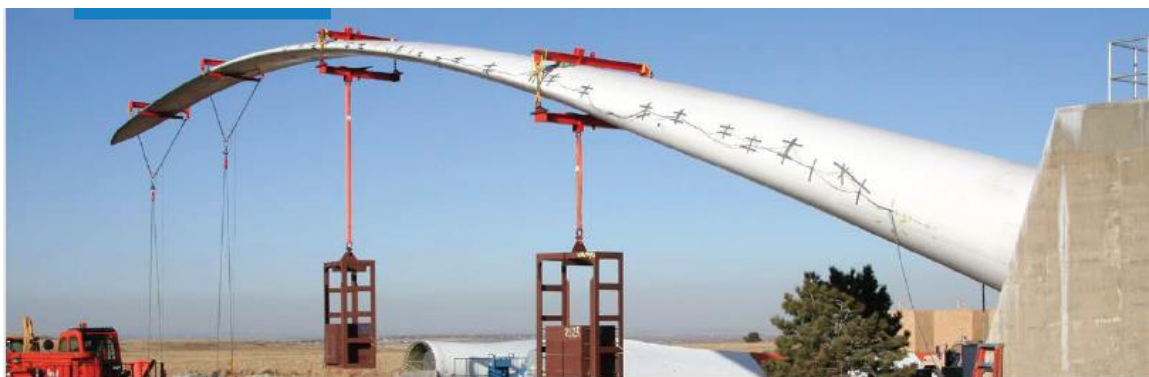
شکل ۳-۲. آزمون بارگذاری استاتیکی بر روی پره توربین بادی
