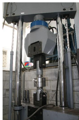
شکل ۲-۵: دستگاه کشش یونیورسال جهت کالیبره نمودن سلول های بار
