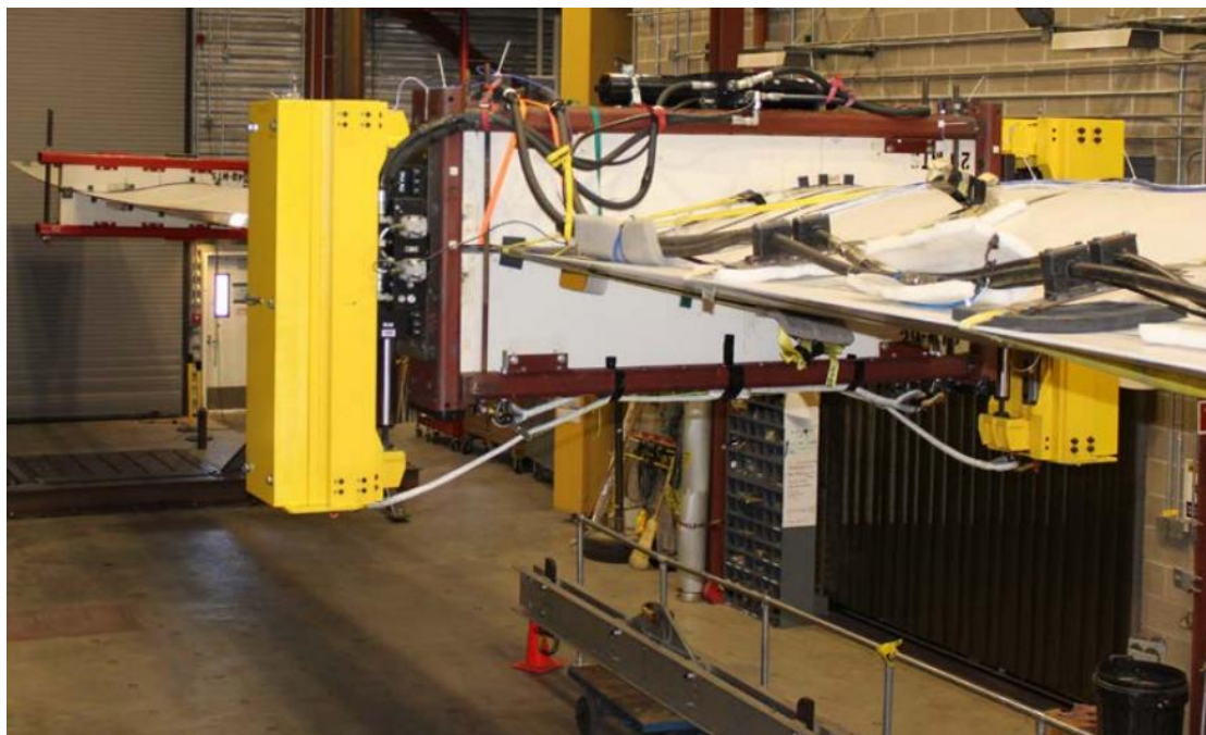
شکل ۳-۳. ارزیابی خستگی پره توربین بادی
