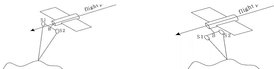
شکل ۲-۱۶- هندسه تداخل سنجی تک مسیری: (تصویر چپ) روش تداخل سنجی در راستای پرواز، (تصویر راست) روش تداخل سنجی در راستای عمود بر پرواز.
