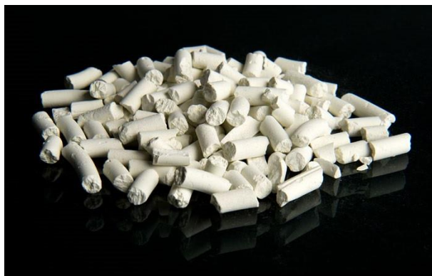
شکل ۱-۷- کاتالیست سولفورزدایی از جریان گاز طبیعی
