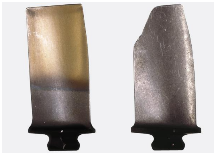
شکل ۳-۴- مقایسه عملکرد یک پره کمپرسور بدون پوشش با پره پوشش داده شده با نانوساختار نیتريد تیتانیوم
