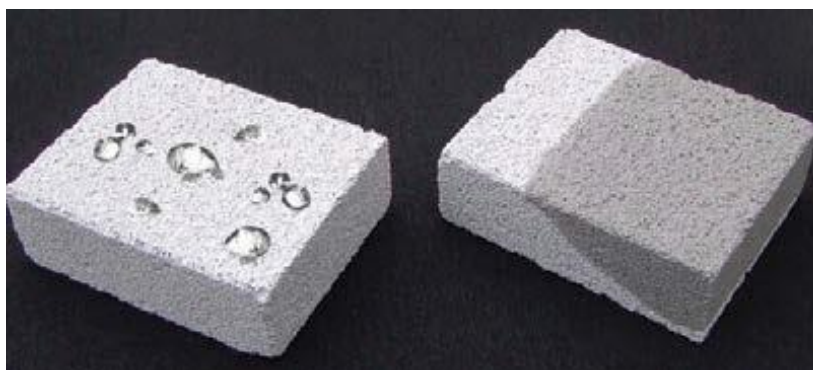
شکل ۳-۱۰- مقایسه میزان جذب آب در بتن با پوشش نانو و بدون پوشش
