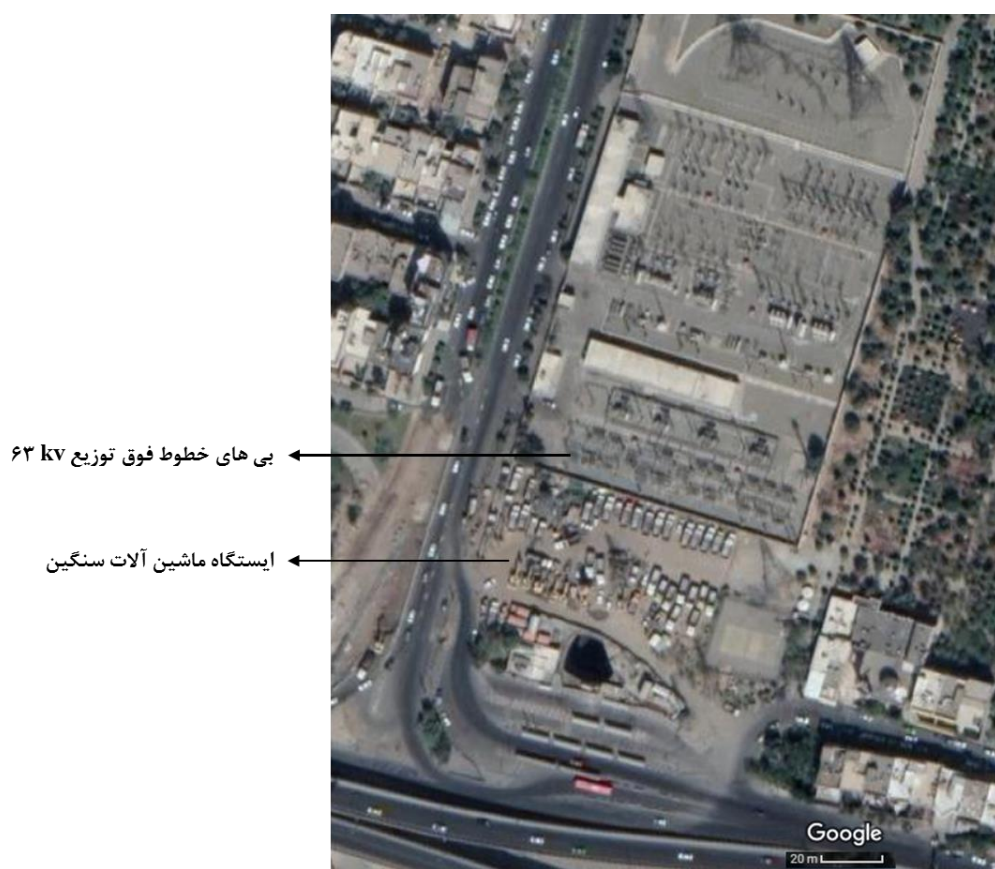
شکل ۴-۳- تصویر هوایی پست ازگل نشان دهنده مجاورت تجهیزات باس و بی های خطوط فوق توزیع ۶۳ Kv با ایستگاه پارکینگ ماشین آلات سنگین
