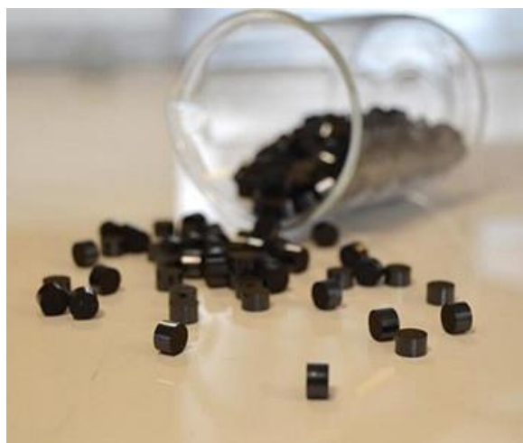
شکل ۱-۹- قرص‌های کوچک کاتالیست انتقال آب-گاز دما پایین
