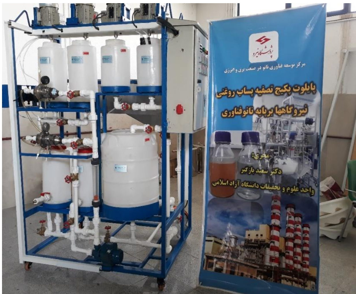
شکل ۴-۱۵- دستگاه تصفیه پساب نیروگاهی بر پایه نانوفناوری
