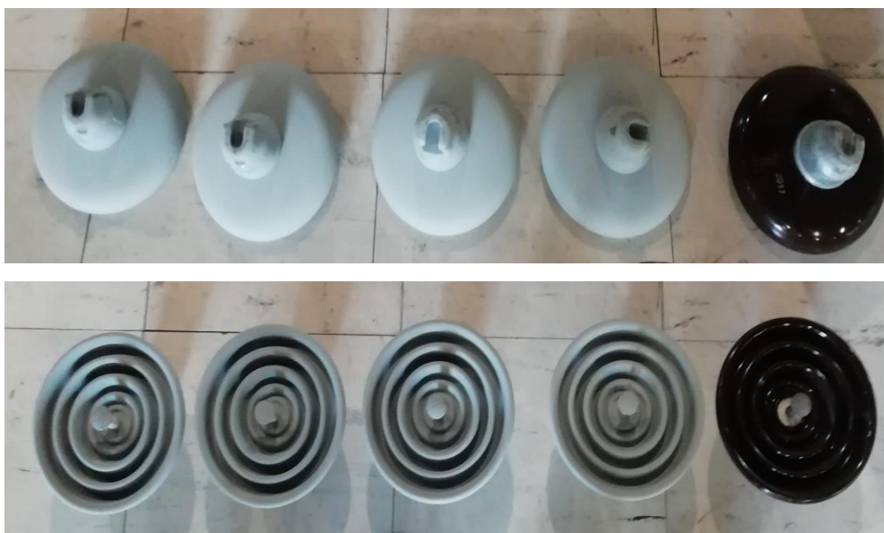
شکل ۳-۸- مفره‌های پوشش داده‌شده با نانو کامپوزیت RTV-SiO 2
