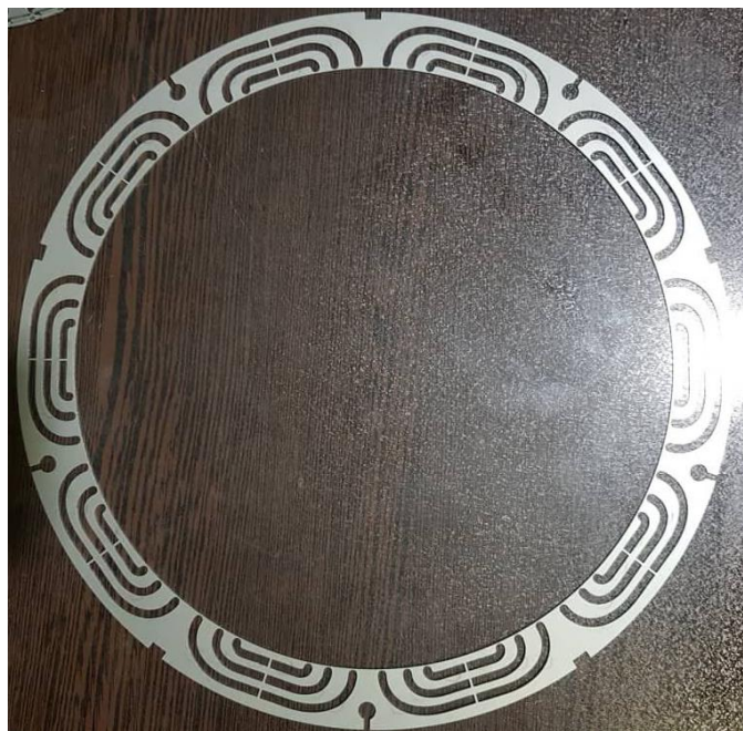
شکل ۱۵-۵: ورق الکتریکی برش خورده مربوط به روتور
