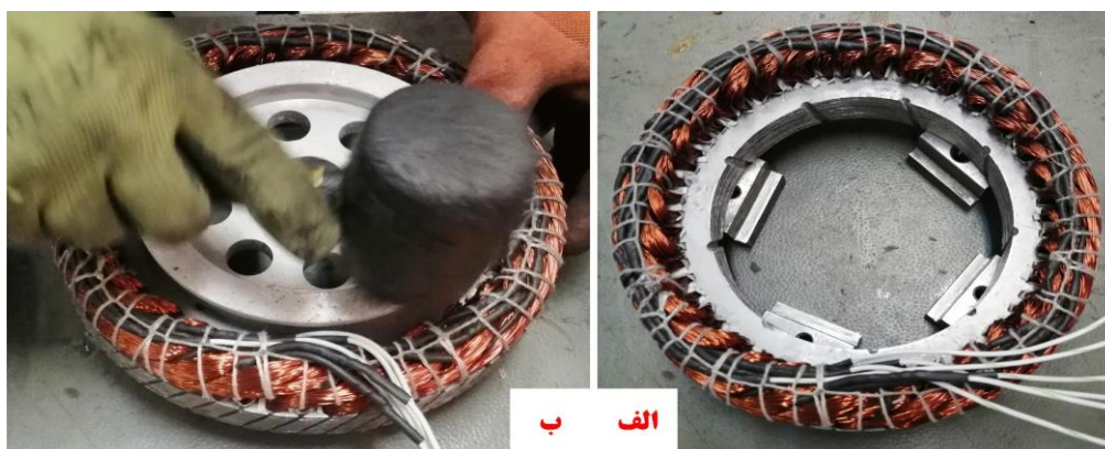
شکل ۱۱= ۶: الف) قرار دادن ۴ قطعه نگهدارنده زیر استاتور برای جلوگیری از آسیب دیدن سیم پیچی بر اثر ضربه ب) استفاده از چکش نرم برای زدن ضربه به منظور جا رفتن نگهدارنده
