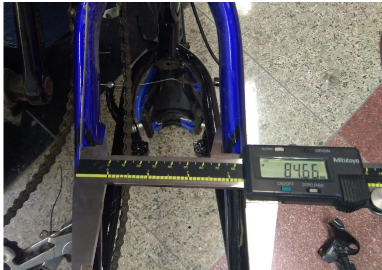
شکل ۲۱-۵: کمترین فاصله بین دوشاخ در بیشترین قطر موتور
