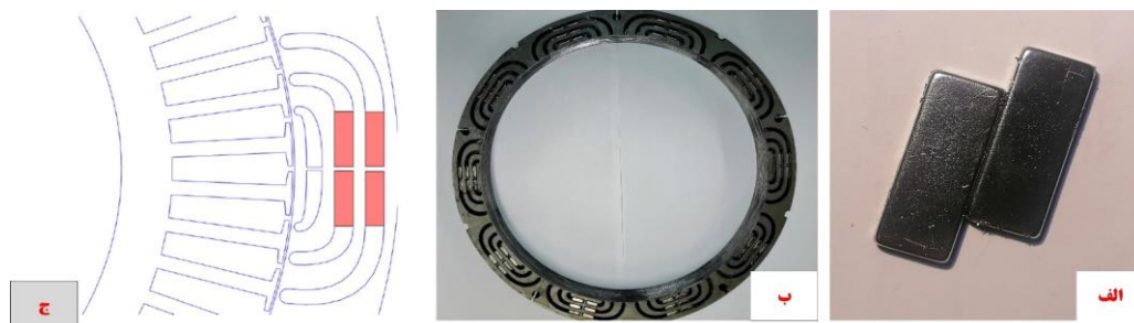
شکل ۳-۶: الف) نمایی از آهنربای NdFeB ب) نمایی از رتور ساخته شده به همراه مونتاژ آهنرباها ج) هندسه بریر رتور
