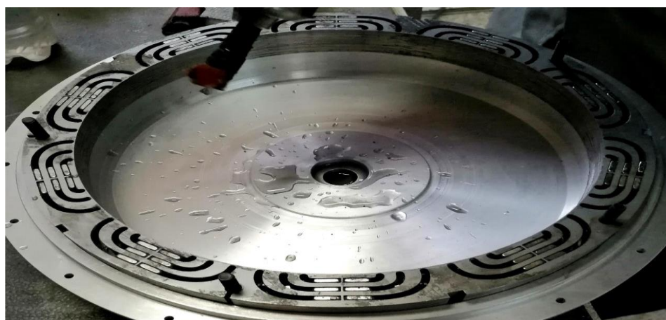
شکل ۱۴-۶: لایه برداری از قطر داخلی درپوش
