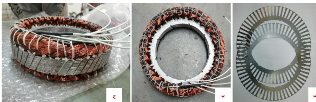
شکل ۴-۶: الف) ورقه های استاتور ب) نمای بالا از استاتور سیم پیچی شده ج) نمای کناری استاتور
