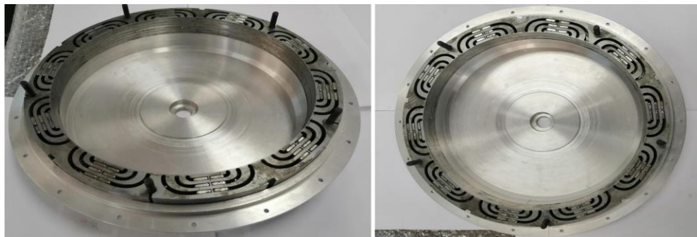
شکل ۹-۶: روتور فیکس شده داخل درپوش
