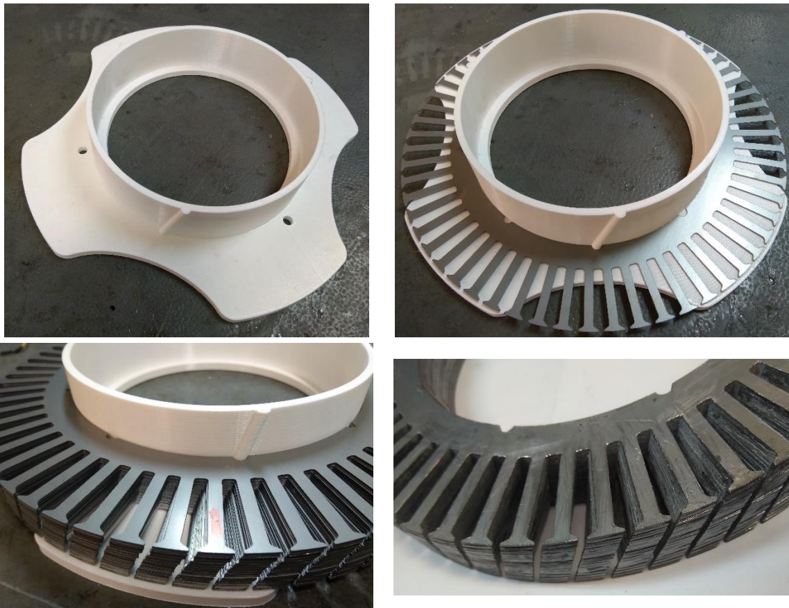
شکل ۷-۵: فرآیند مورب کردن هسته استاتور
