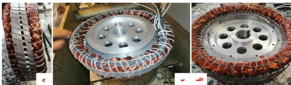
شکل ۱۲= ۶: الف) نمای داخلی باز شدن ورقه های استاتور زیر پرس ب) مجموعه استاتور زیر پرس ج) نمای بیرونی باز شدن ورقه های استاتور
