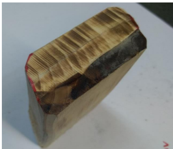
شکل ۱۰-۵: قالب آماده شده جهت تولید کوئلها
