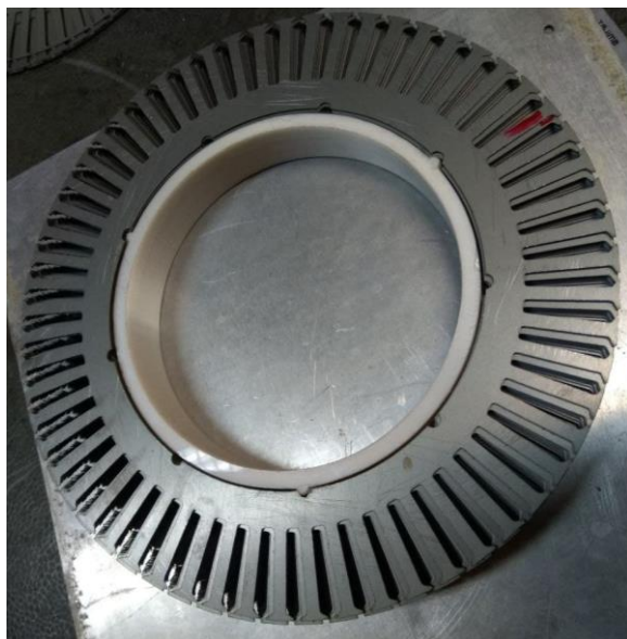
شکل ۶-۵: سعی در ساخت هسته مورب استاتور به کمک قالب اسکيو شماره ۱
