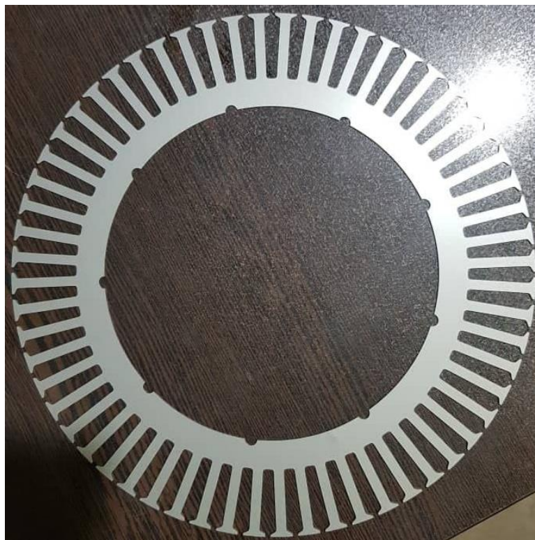
شکل ۳-۵: ورق الکتریکی برش خورده مربوط به هسته استاتور
