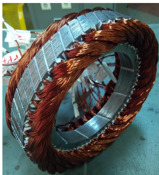
شکل ۵-۰: هسته استاتور پس از اتمام سیم پیچی
