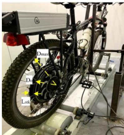
شکل ۳-۳۱: BLDCM تجاری که روی دوچرخه الکترونیکی در آزمایشگاه با محدودیت‌های ابعادی مرتبط نصب شده است.
