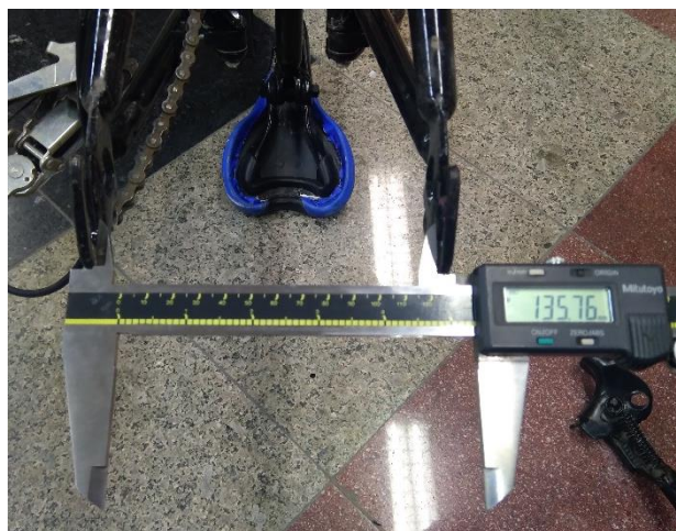
شکل ۲۰-۵: فاصله بین دوشاخ چرخ عقب
