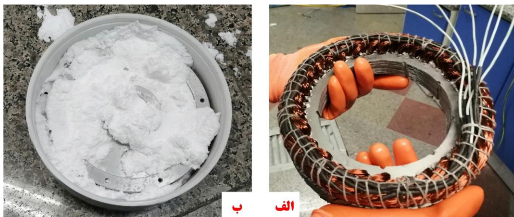
شکل ۱۰= ۶: الف) روتور حرارت داده شده در کوره ۷۰ درجه ب) نگهدارنده در حال سرد شدن با یخ خشک
