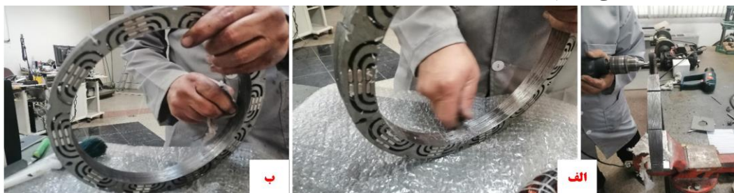
شکل ۸-۶: (الف) تمیز کردن چسب های باقیمانده روی بدنه روتور (ب) تمیز کردن براده های آهن باقیمانده روی روتور
