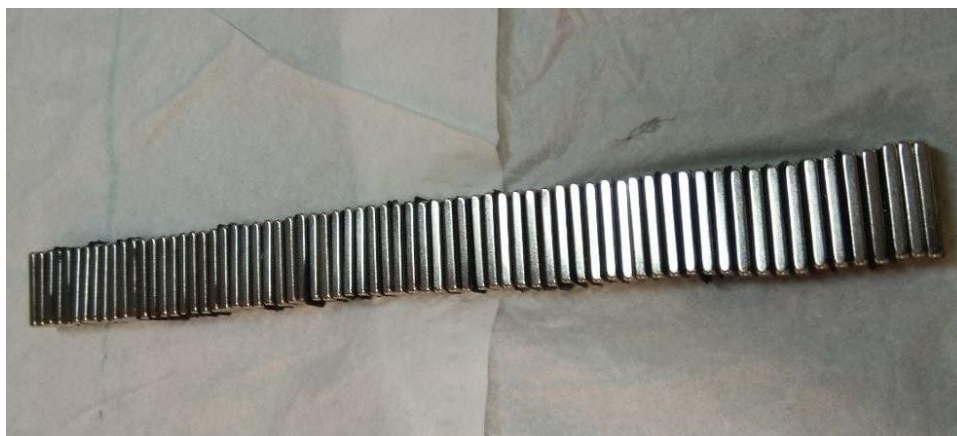
شکل ۱۷-۵: مرتب کردن آهنرباها قبل از جایگذاری در روتور
