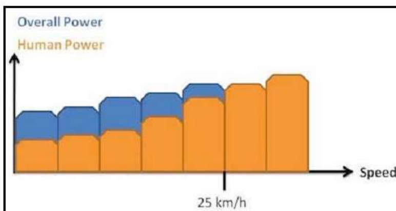
شکل ۱-۱: نمودار توان - سرعت دوچرخه های Pedelec
