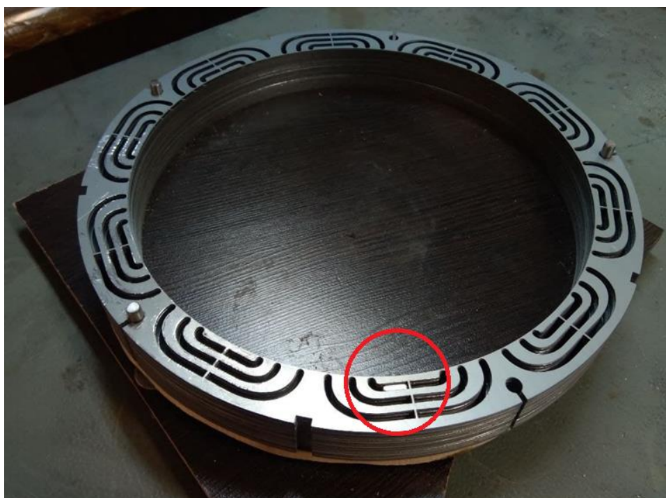
شکل ۱۸-۵: فیکسچر آماده شده برای ساخت هسته روتور
