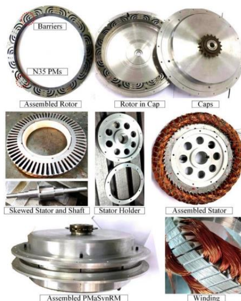
شکل ۳۱-۵: بخش‌های مختلف نمونه اولیه PMaSynRM.
