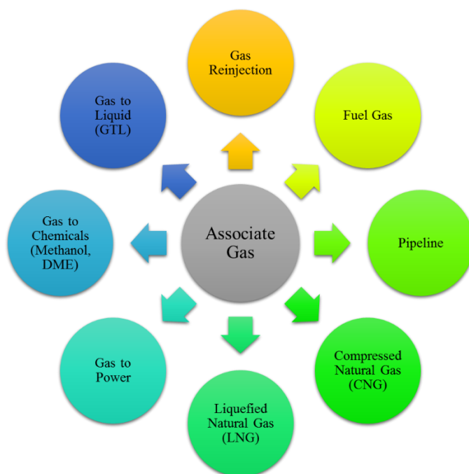
شکل ۲- انواع روش‌های بازیابی و بکارگیری گاز فلر [۳]
